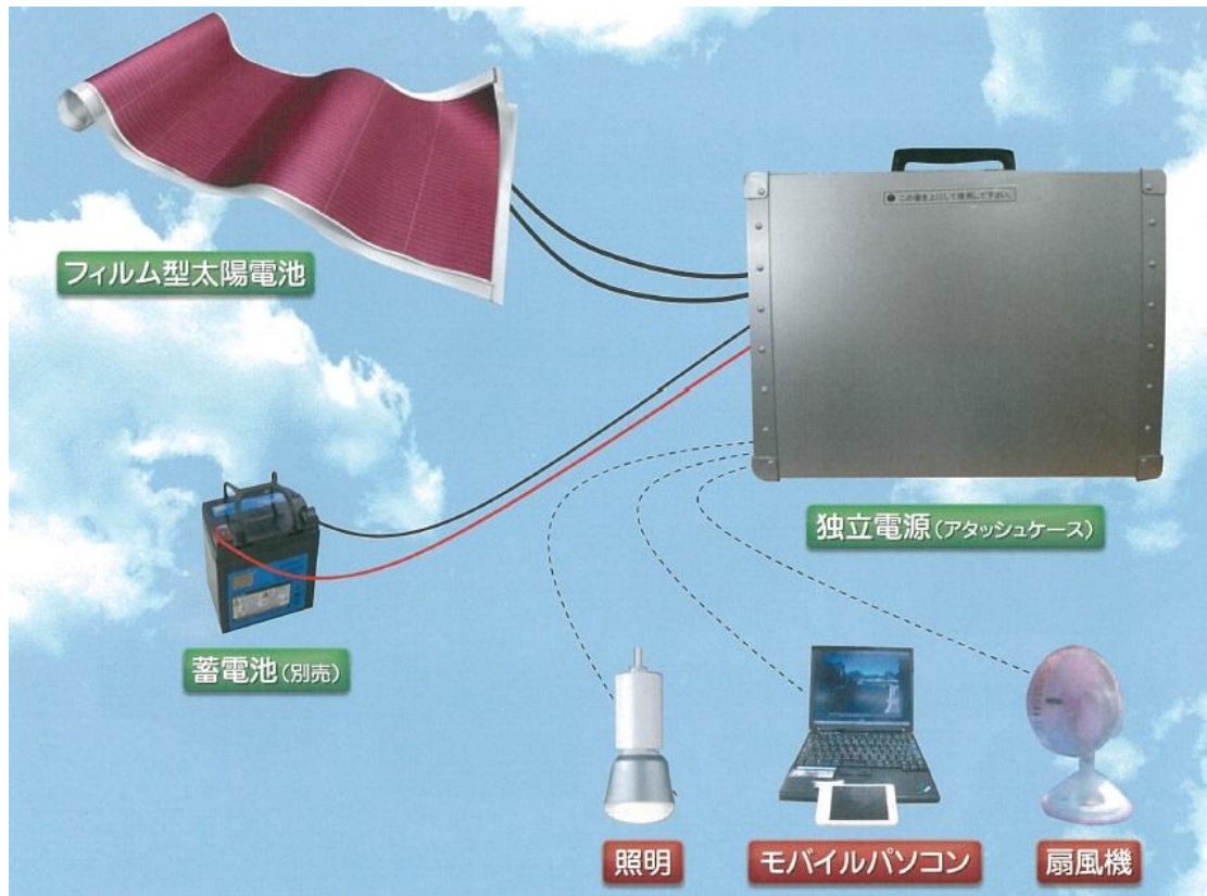
圖 24 緊急電源設備
