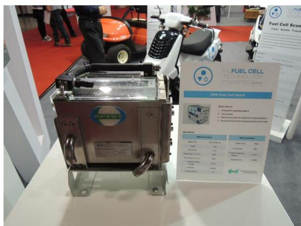
圖 10 台灣燃料電池聯盟參展 PEMFC Stack (2.5 kW)。
