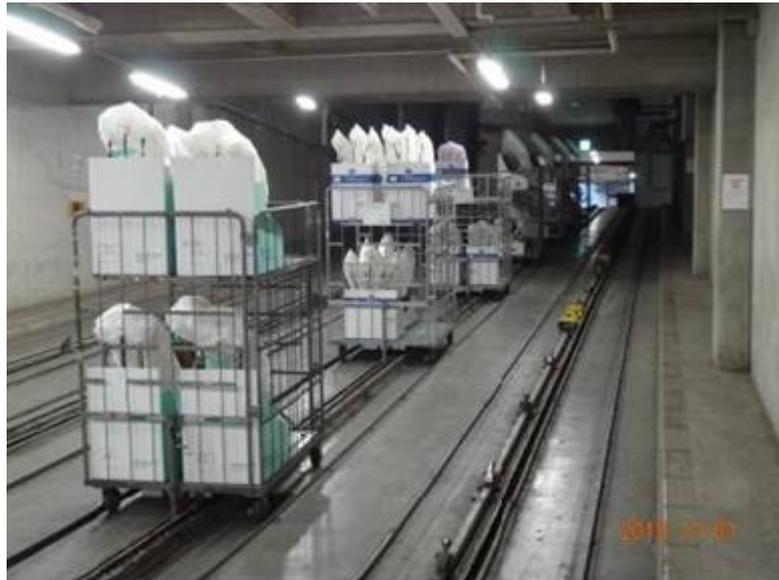
圖 15、輸送鏈條帶動料架台車實際運作圖
