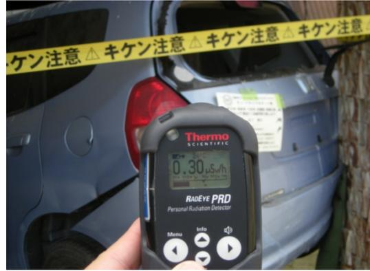
圖 6 受損小轎車前的輻射劑量為每小時 0.3 微西弗
