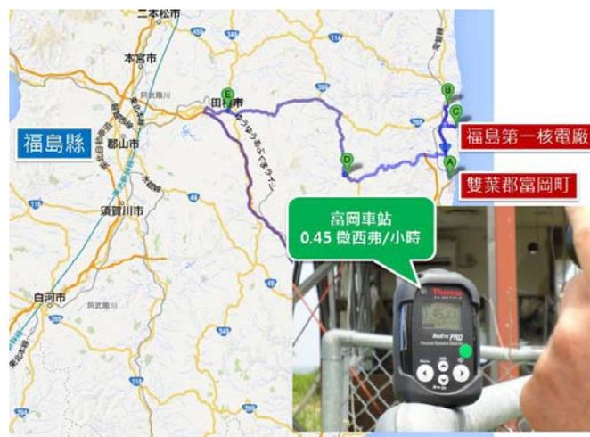
圖 4 富岡車站輻射劑量率在 0.45 微西弗/小時
