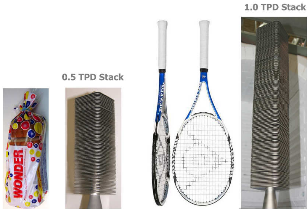
圖 3-7. ITM 不同氧氣產量下模組的厚度比較
