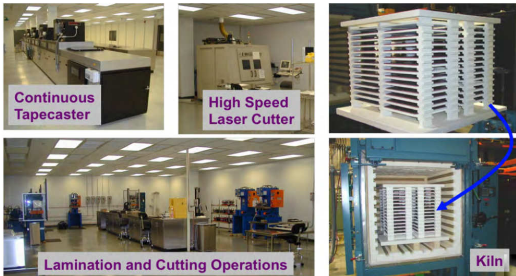
圖 3-5. Air Products 的 ITM 薄膜製作流程
