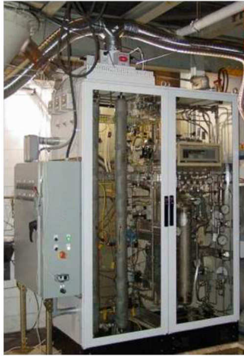
圖 3-18. Air products 建立的 Sour-PSA 設備
