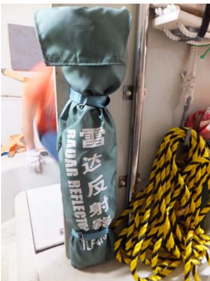
圖 56 救生筏上備有雷達反射器以利
