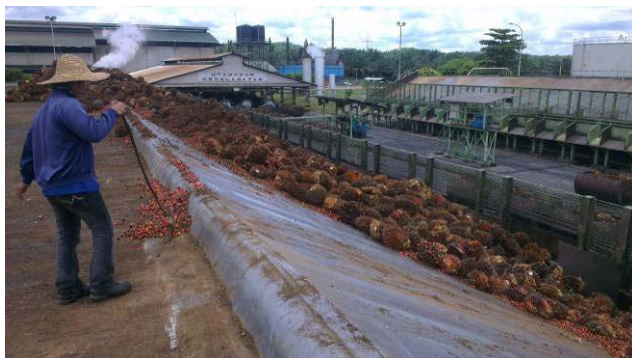
榨油廠生棕櫚串傾卸平台
