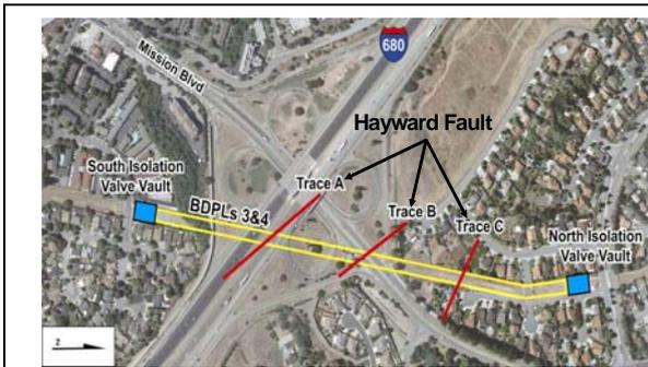
圖 3.3-12 幹管穿越 Hayward fault [4]
