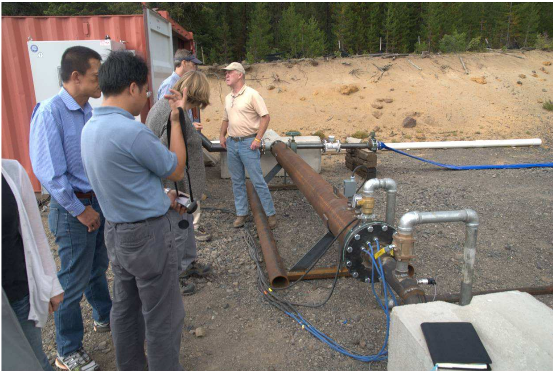
圖24：Newberry EGS示範試驗場之加壓注水設備
