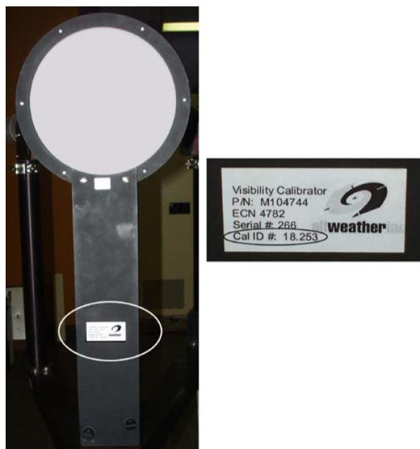
圖 2-7 校驗短舵上的 Cal ID 標記值
