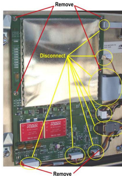
圖 1-10 資料擷取電路板上與各模組間連接的接頭（黃圈所示）
