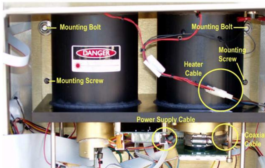
圖 1-11 光學模組與各模組間連接的接頭（黃圈所示）
