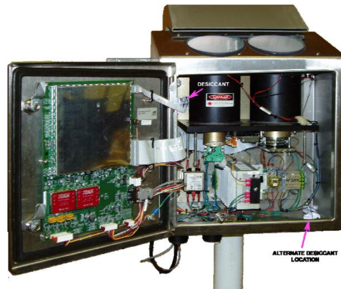
圖 1-8：雲高儀 8339 乾燥劑包裝更換位置圖
