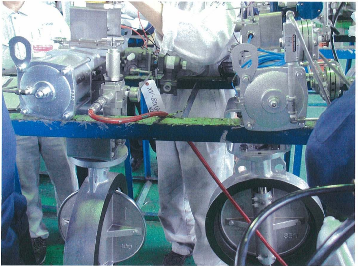
圖十五 日本NBS公司ON-OFF控制閥 XV-8013功能測試
