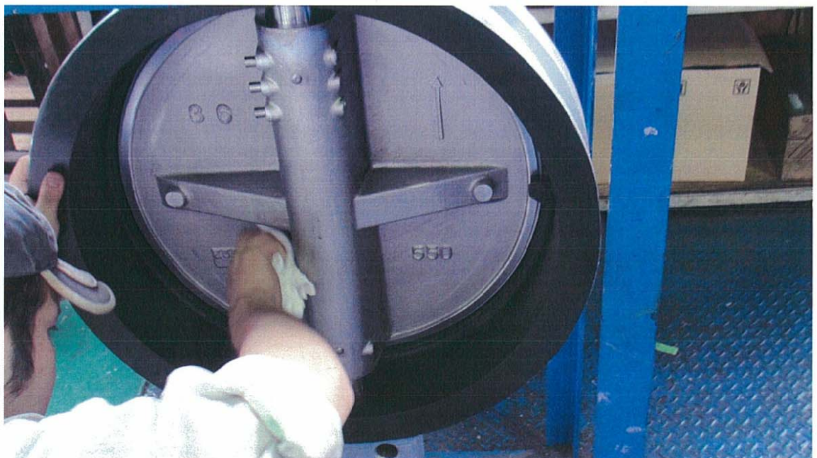
圖十六 日本NBS公司控制閥內部清潔度檢查
