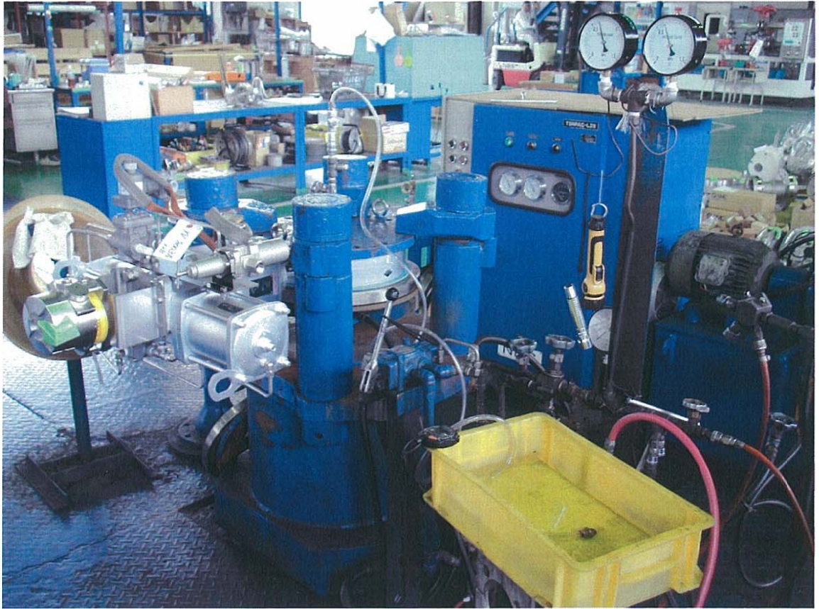
圖十三 日本NBS公司控制閥 XV-8003A閥座洩漏測試
