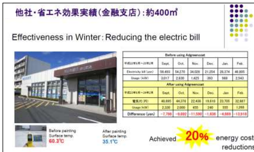
圖四、NCK 隔熱塗料產品 Adgreencoat 應用實例二，面積 400 平方公尺的南日本銀行屋頂的隔熱塗裝工程。
