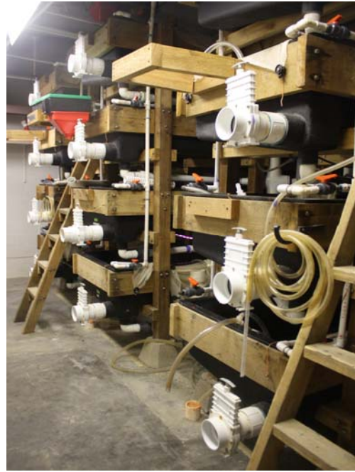
多層淺水渠道式養蝦系統
