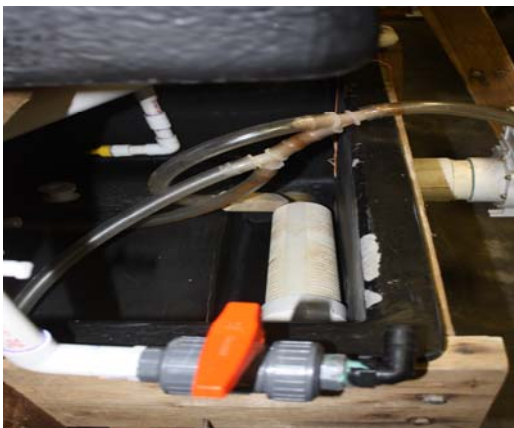
多層淺水渠道式養蝦系統進水流水設計
