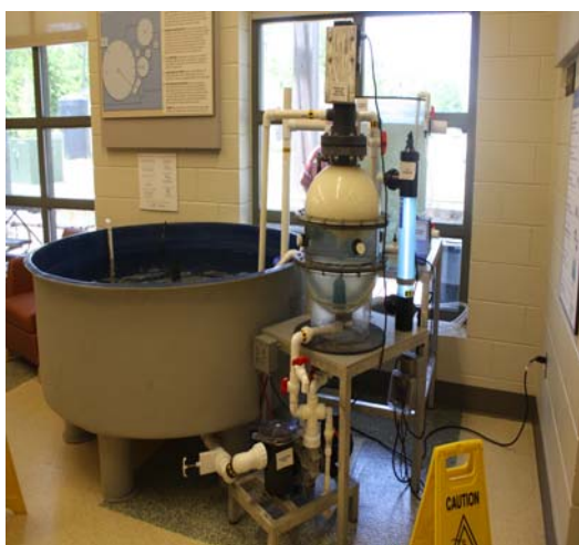
水族養殖過濾循環系統之模型運作展示
