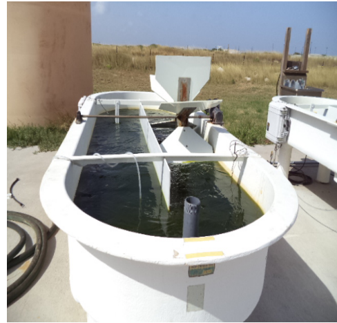
流水渠道設施培養擬球藻
