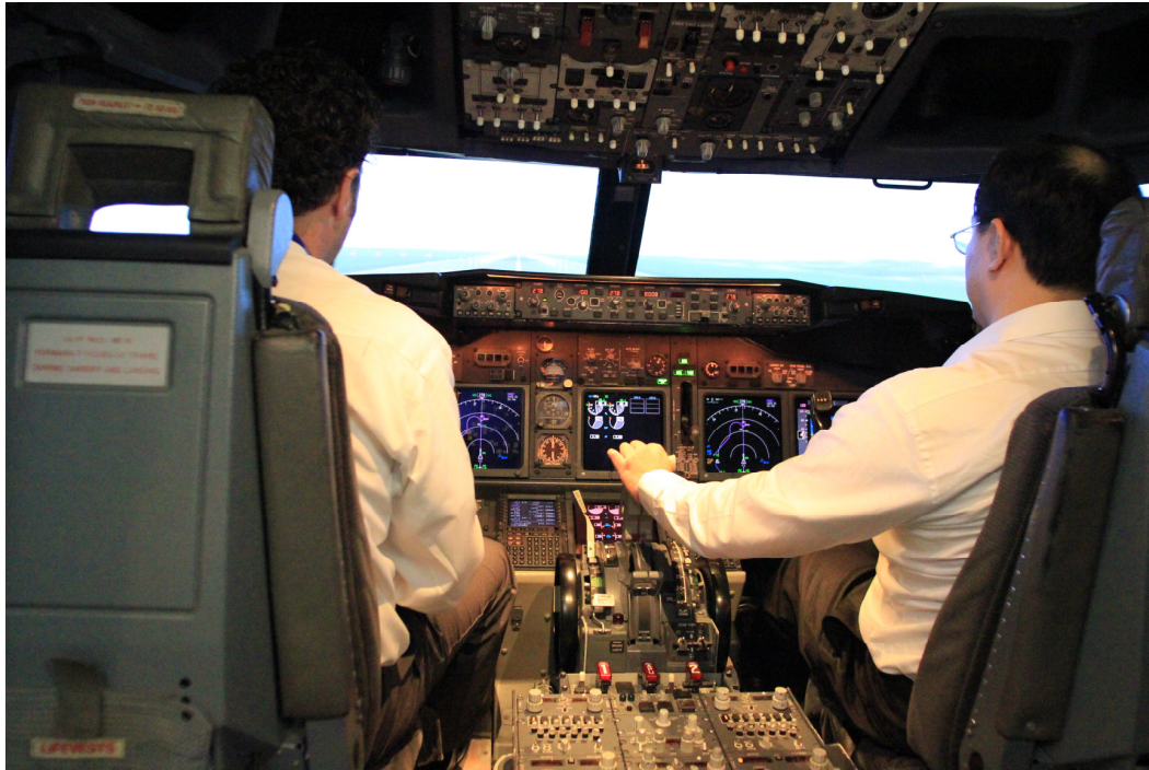
使用波音 B737NG 模擬機驗證 RNP-AR 程序編碼成果
