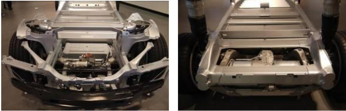
圖 12 特斯拉電動車底盤電池及懸吊系統
