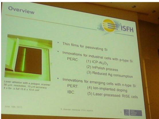
圖六、P 型與 N 型矽晶電池技術改善方式
