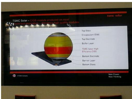
圖四十五、TSMC-CIGS 模組結構
