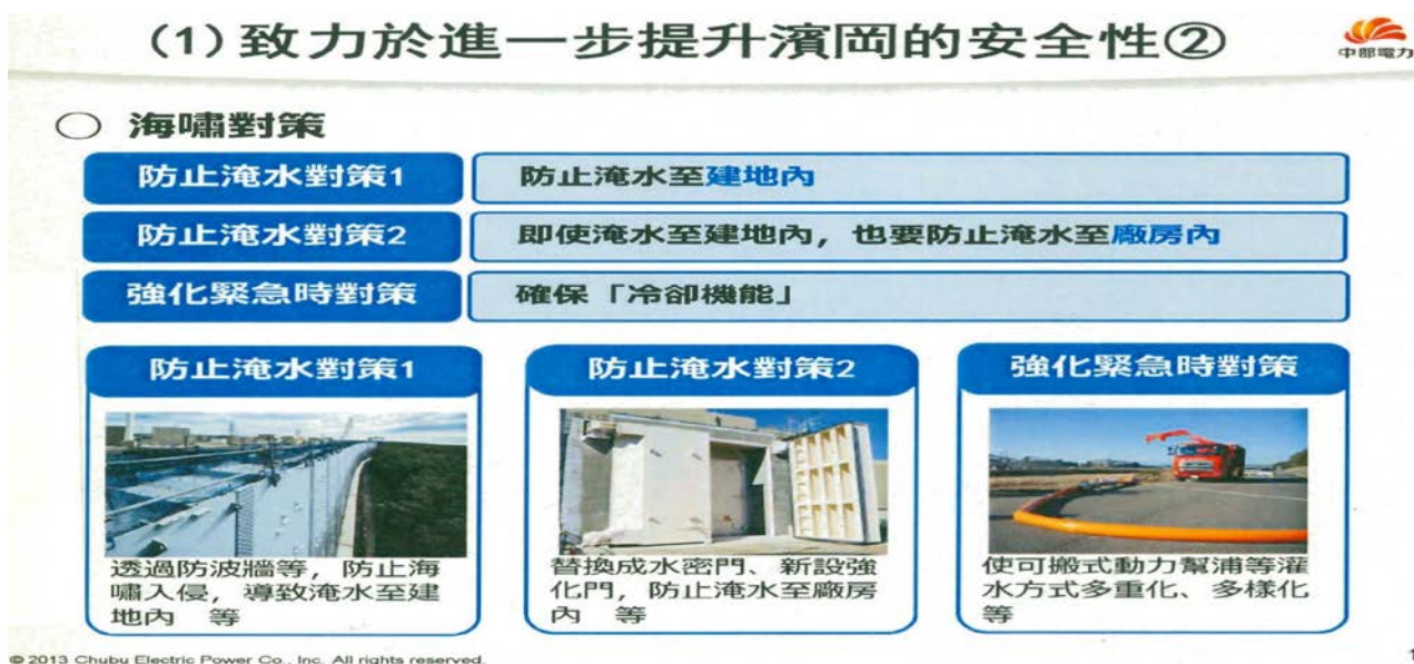
圖24 中部電力濱岡電廠之海嘯對策
