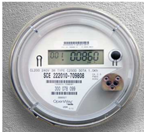
圖 14、SCE 智慧電表-Smart Connect™
