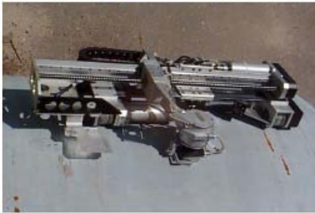
槽壁檢測掃描器
