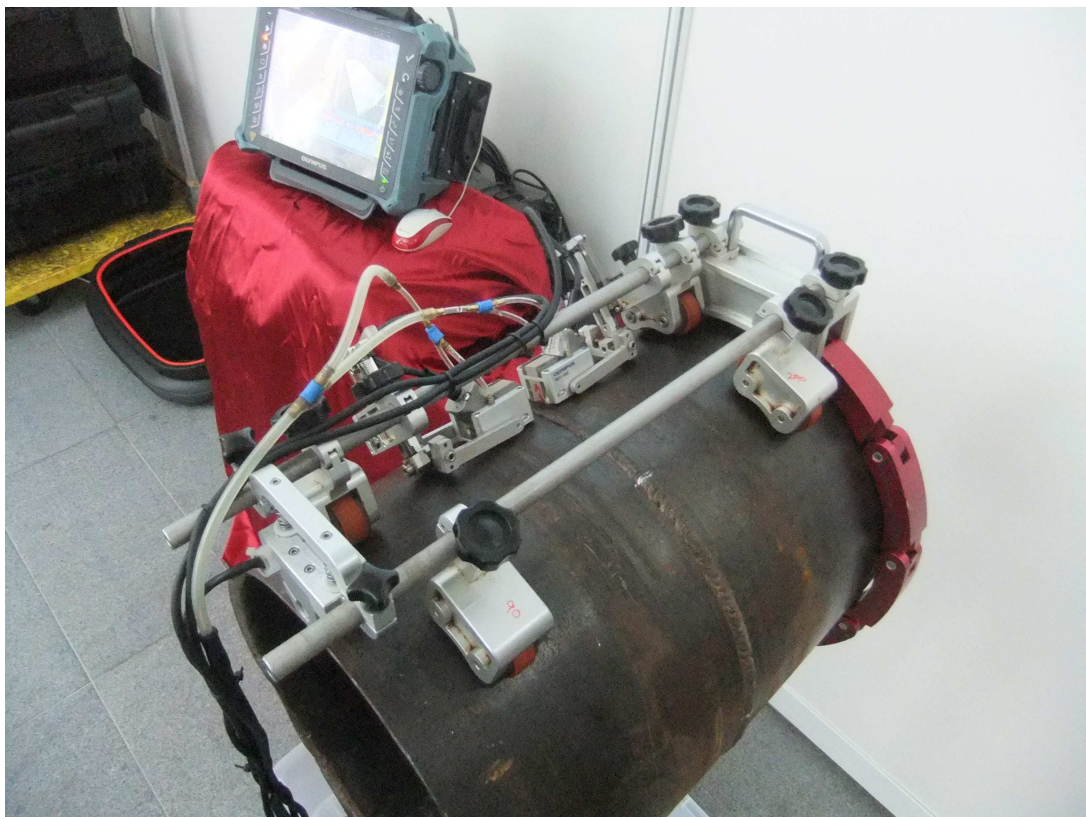
圖2. 陣列式超音波探傷儀展示檢測大型管件缺陷
