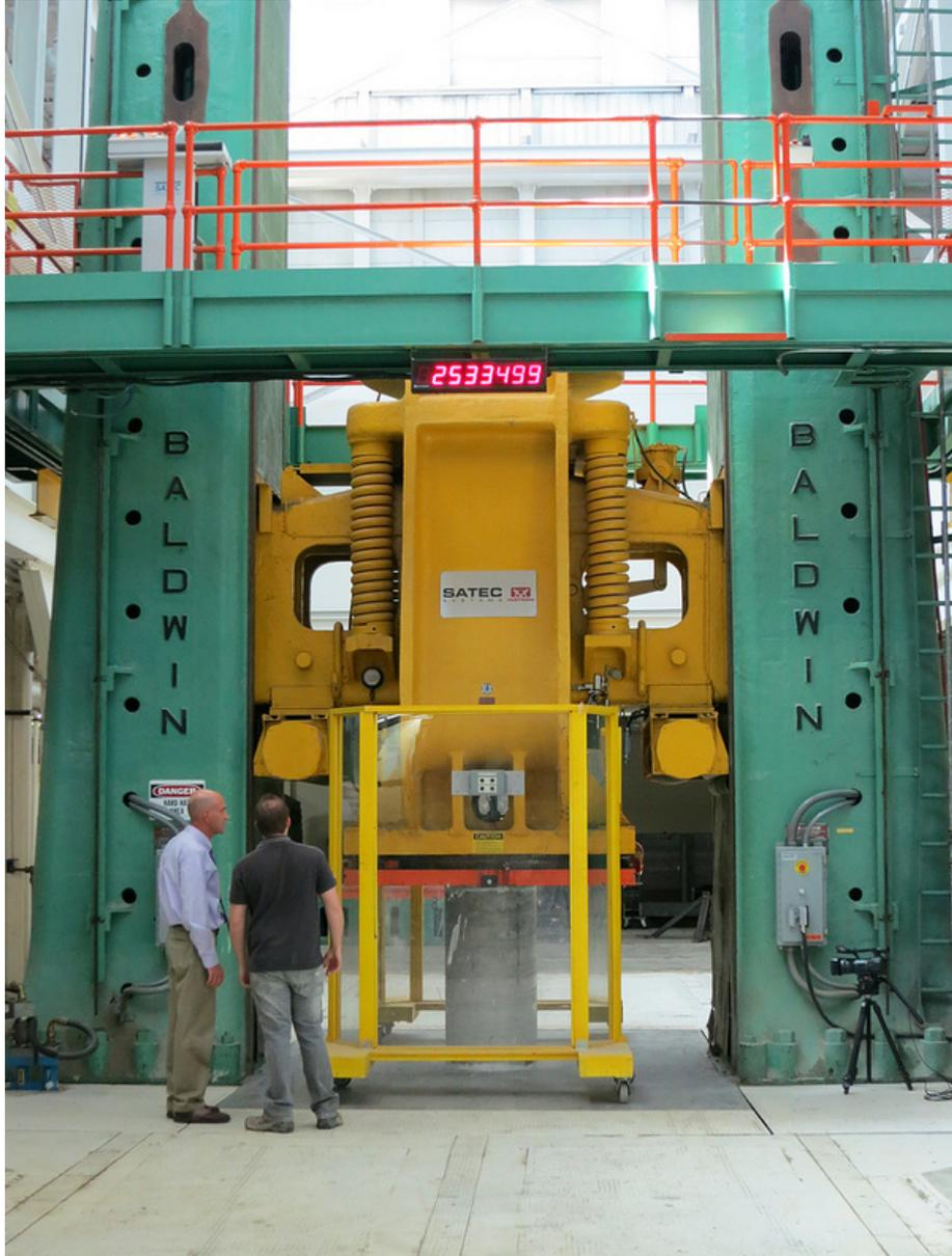
大型混凝土圓柱抗壓試驗(500 萬磅抗壓機)
