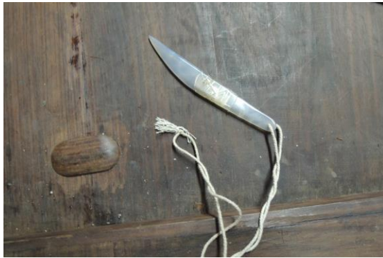
圖 1-10 表面塗蠟研光工具-瑪瑙石，家具表面燙蠟步驟依序為：熔化配蠟→佈蠟→燙蠟→起蠟→擦蠟→抖蠟。研光工序視需要而進行，通常為最後步驟。 筆者攝
