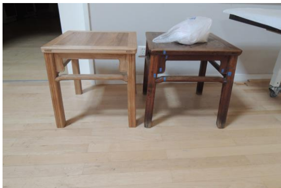
圖 2-15 WMF 培訓中心以梁思成故居之黃花梨方机(右)進行仿製，作為培訓實習生之教材，訓練學生傳統木作工藝及表面燙蠟技術。左為學生之仿製作品。
