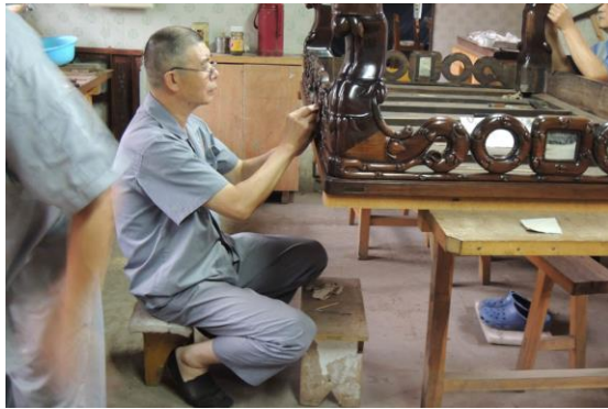
圖 1-9 古建部家具修復工作室-家具修復師傅進行表面塗蠟研光步驟 筆者攝
