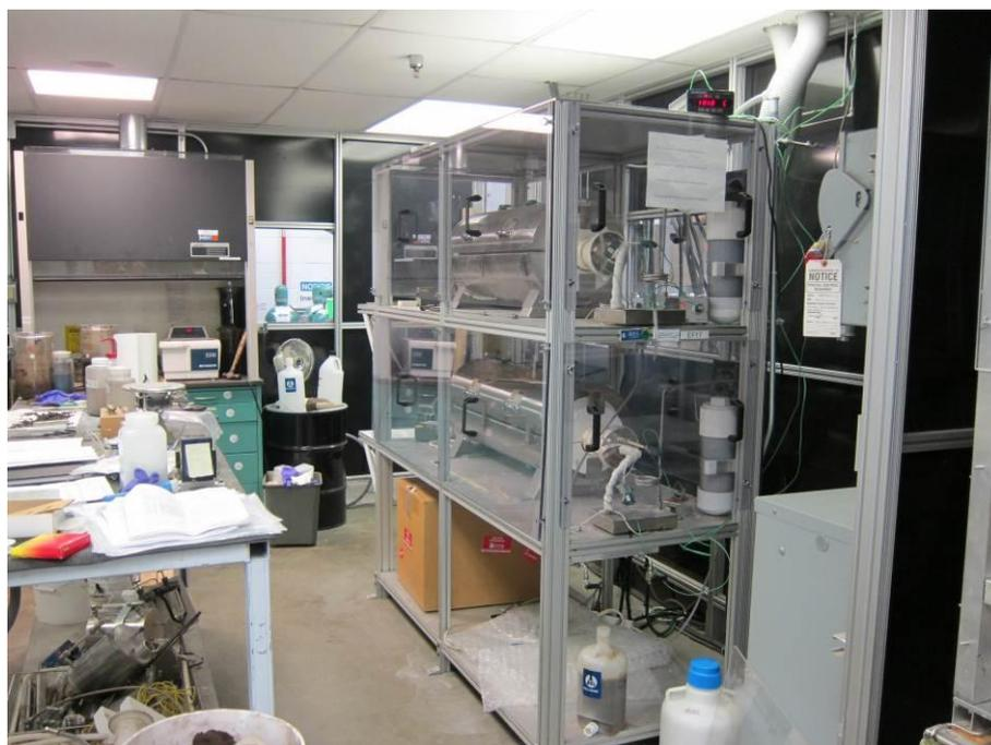
圖 2-13 含硫化物氣氛條件高溫試驗設備
