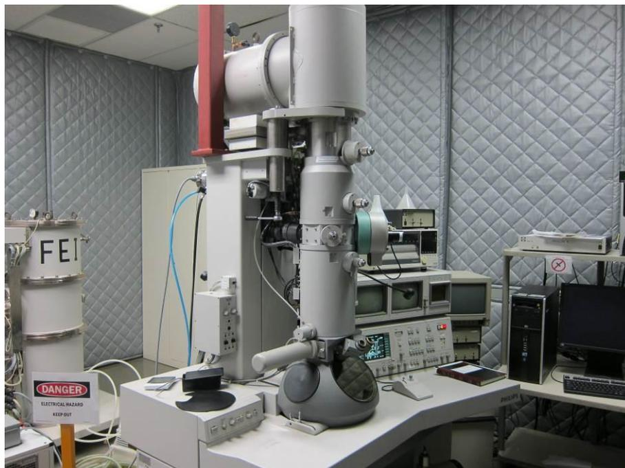
圖 2-17 聚焦式離子束顯微鏡(FIB)
