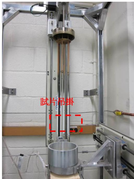
圖 2-9 高溫循環氧化試驗試片吊掛與懸吊系統
