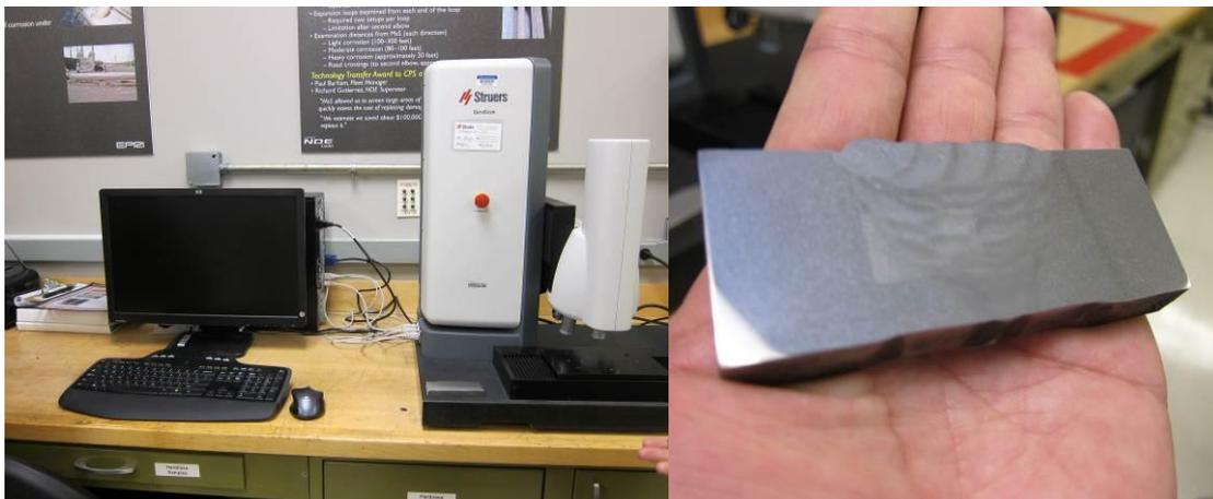
圖 3-38 自動微硬度測試設備與焊道硬度測試樣品
