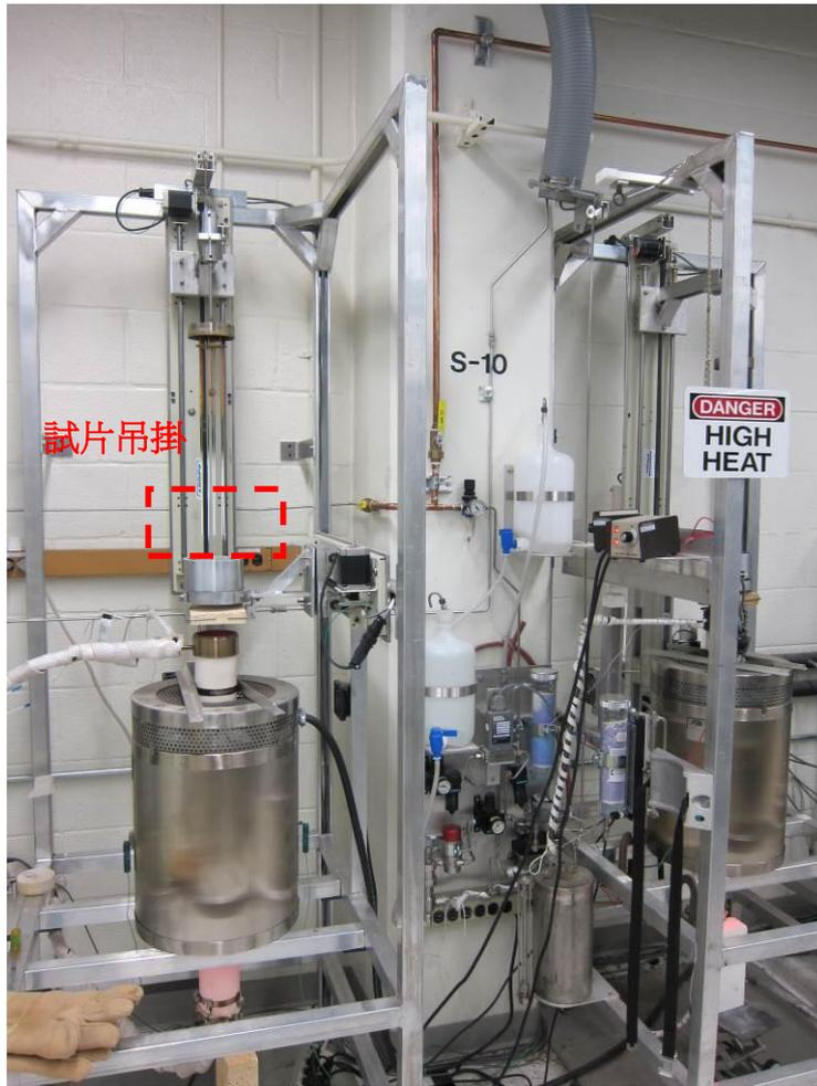
圖 2-8 高溫循環氧化試驗設備
