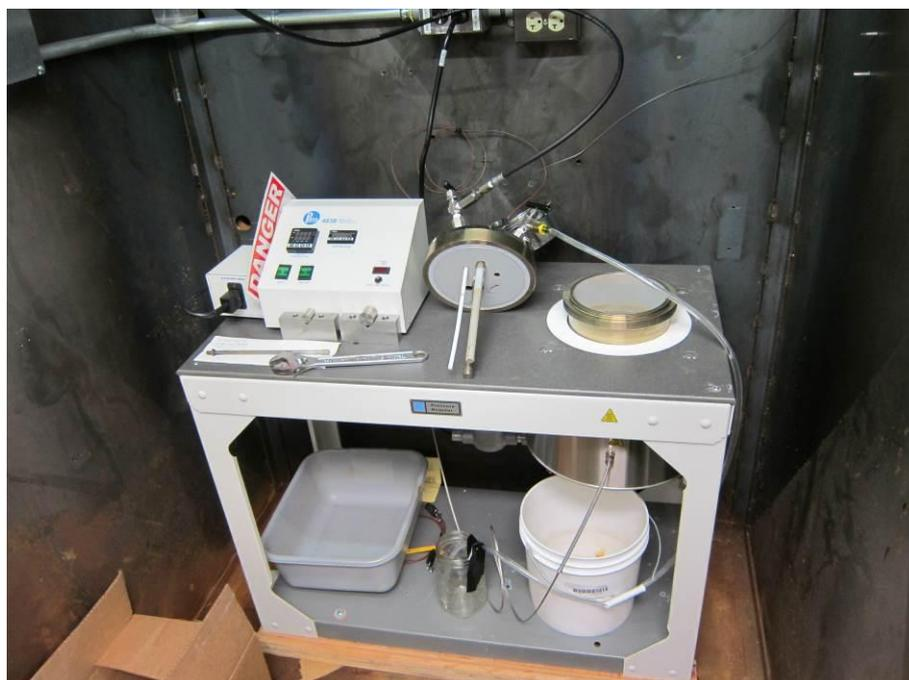
圖 2-15 氫氣氛條件高溫試驗設備
