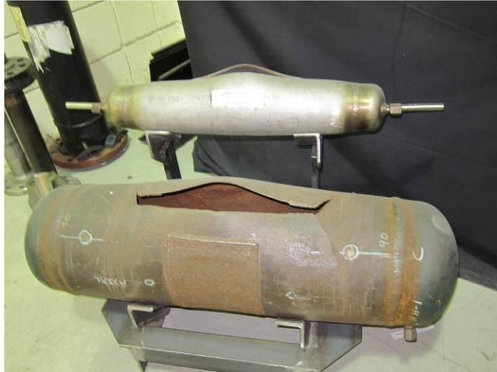
圖 3-36 壓力潛變試驗樣品
