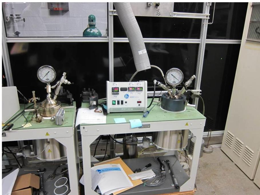
圖 2-14 生質燃料高溫腐蝕試驗設備
