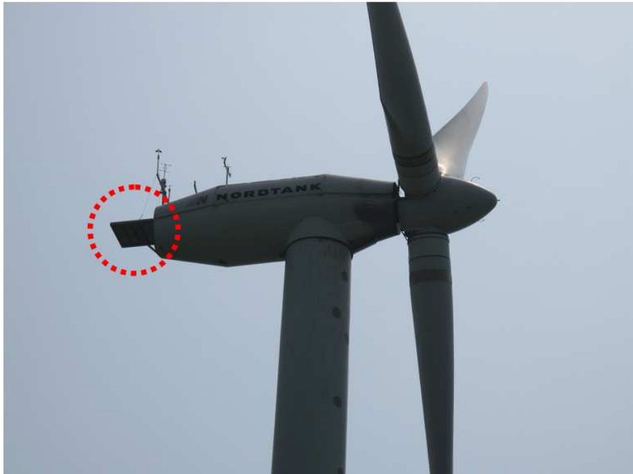
圖1-7 DTU Riso校區Lidar應用於風能預測試驗
