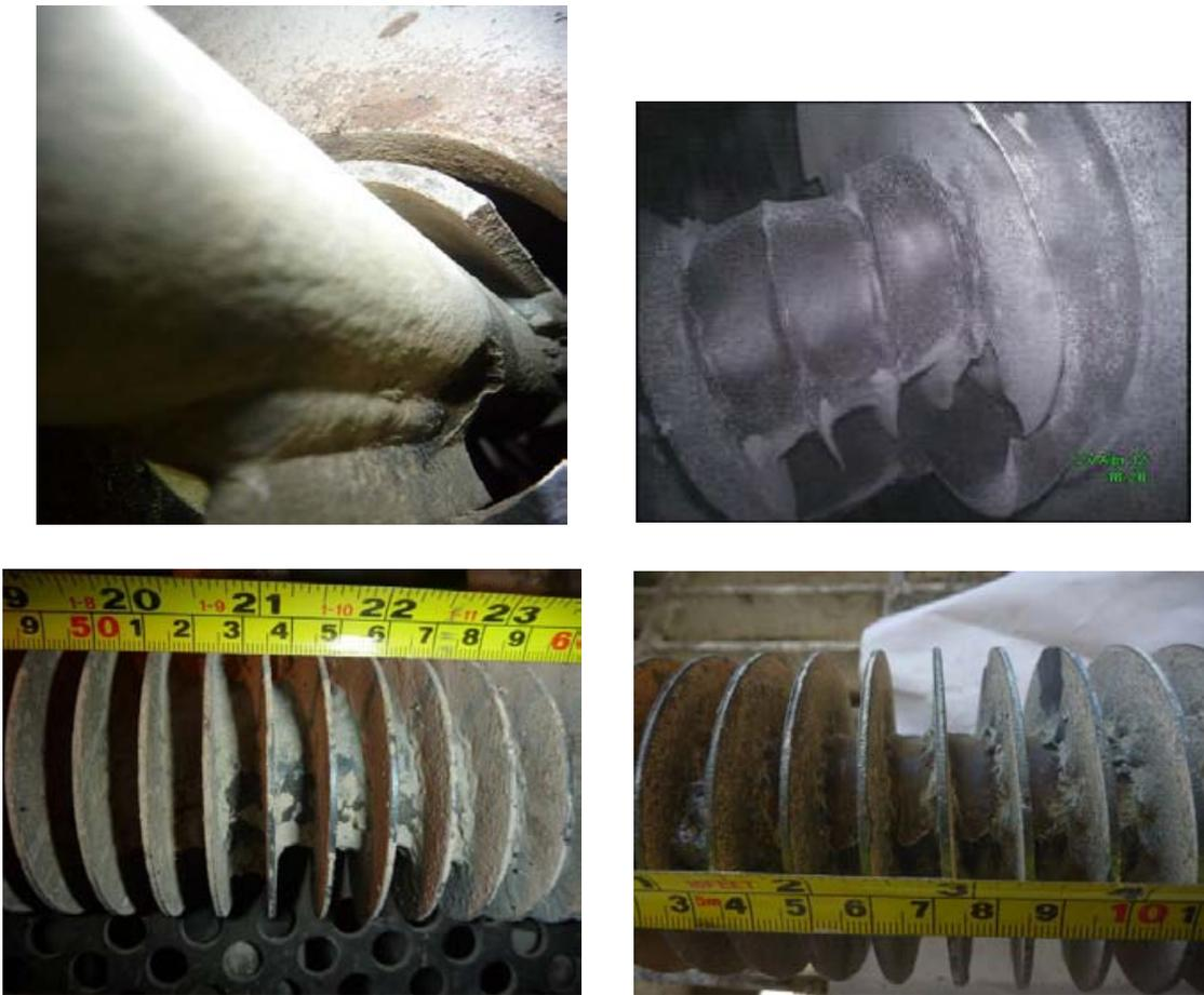
圖(七)、省煤器爐管缺陷樣本
