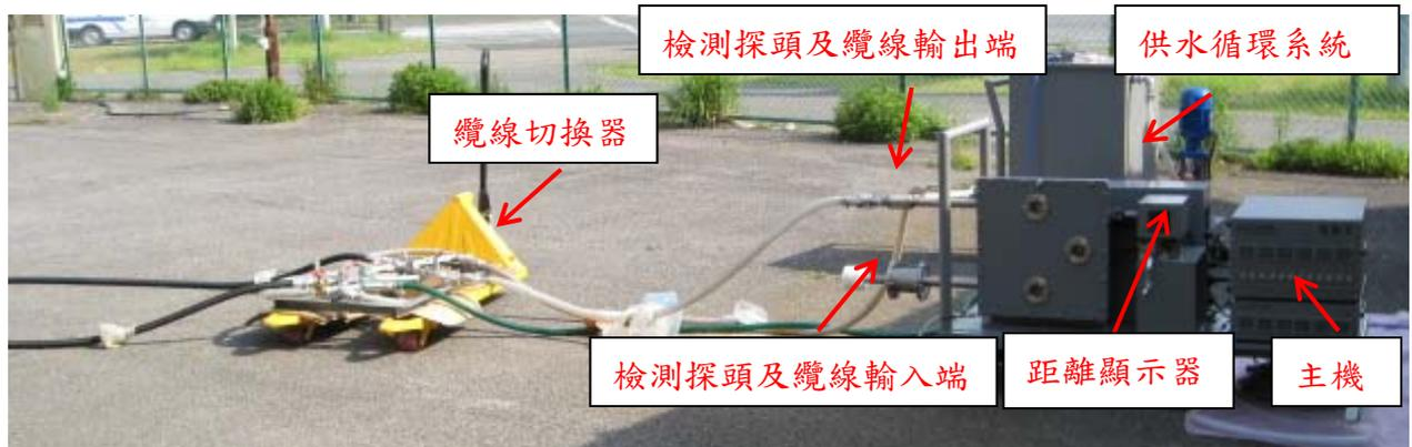
圖(五)、多探頭管內超音波設備
