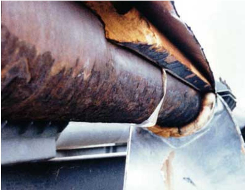
圖(八)、CUI :Corrosion Under Insulation
