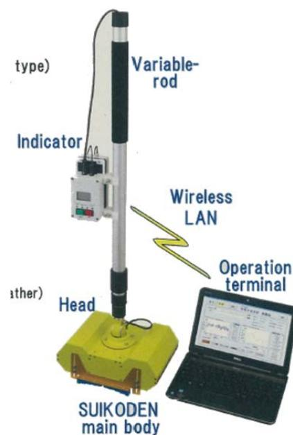
圖(十)、中性水份計設備構造
