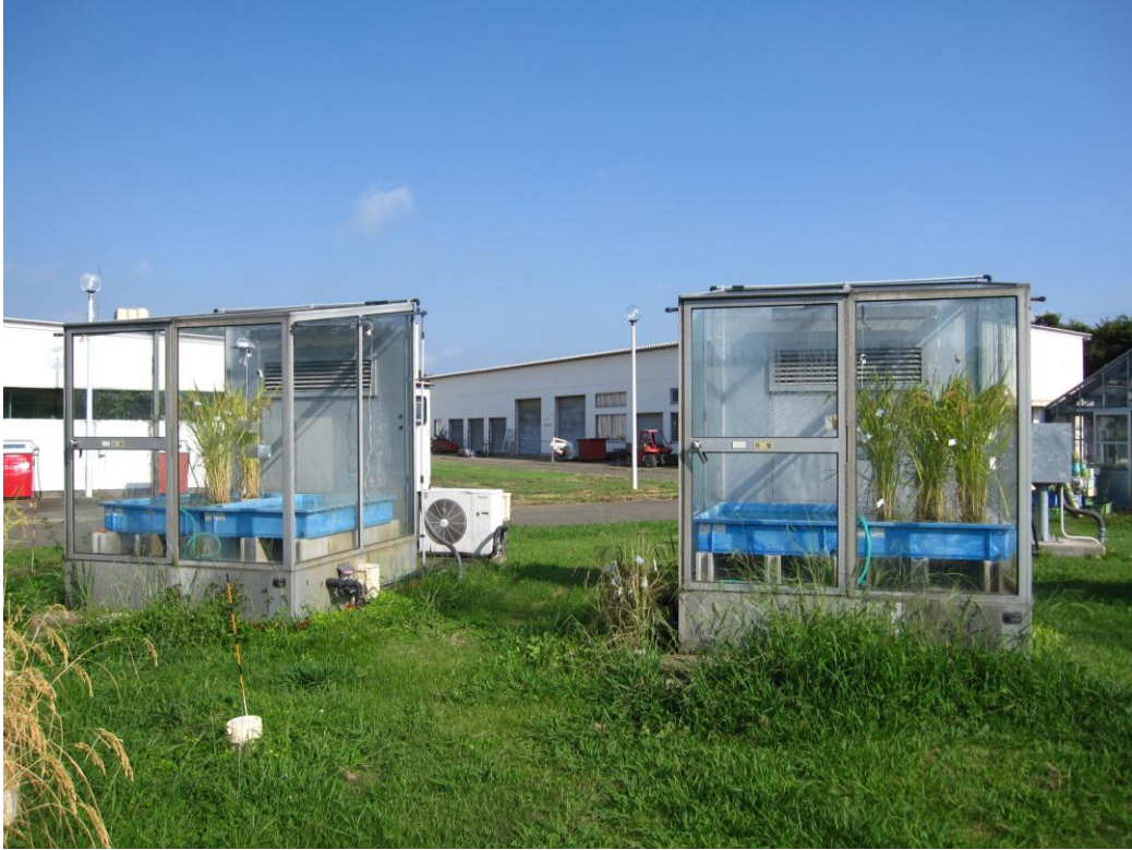
模擬露天的溫室可以維持正常日照同時控制日夜溫
