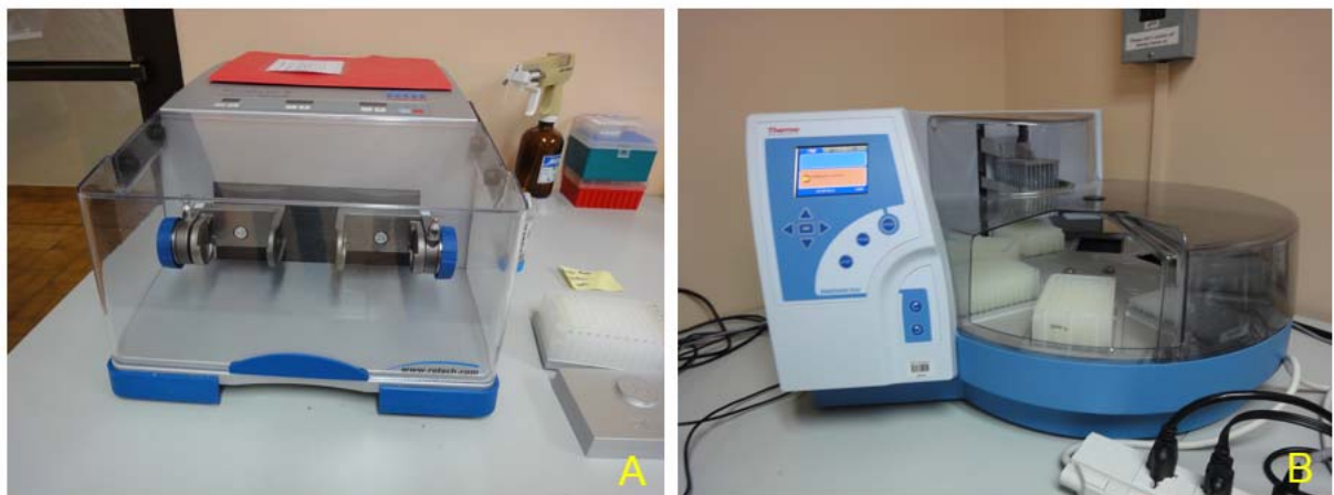
圖 5. DNA 萃取裝置。A. 高速震盪研磨系統 (TissueLyser II)；B. 自動化 DNA 萃取系統。
