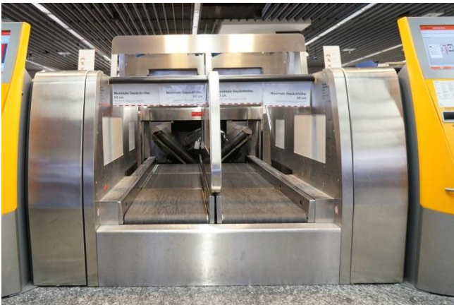
圖 21：自動行李託運 3 (機械自動將行李平放後，送入分檢系統)
