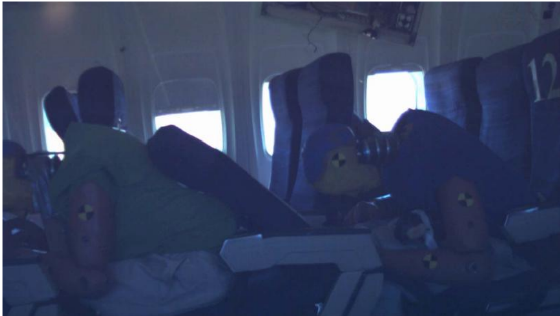
圖 3-9：由實驗機內部預架好的攝影機監控航機觸地時客艙的景況
