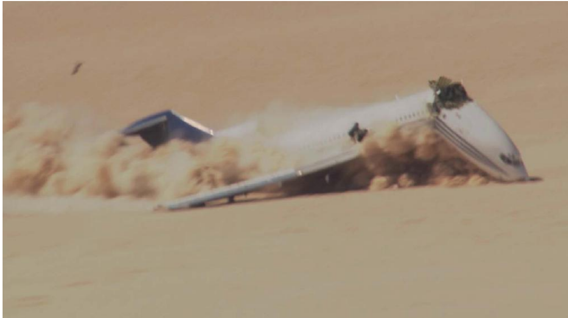
圖 3-8：藉由遙控操控的方式，使一架在撞地前機上已無人員的波音 B727 航機進行生還因素實驗。
