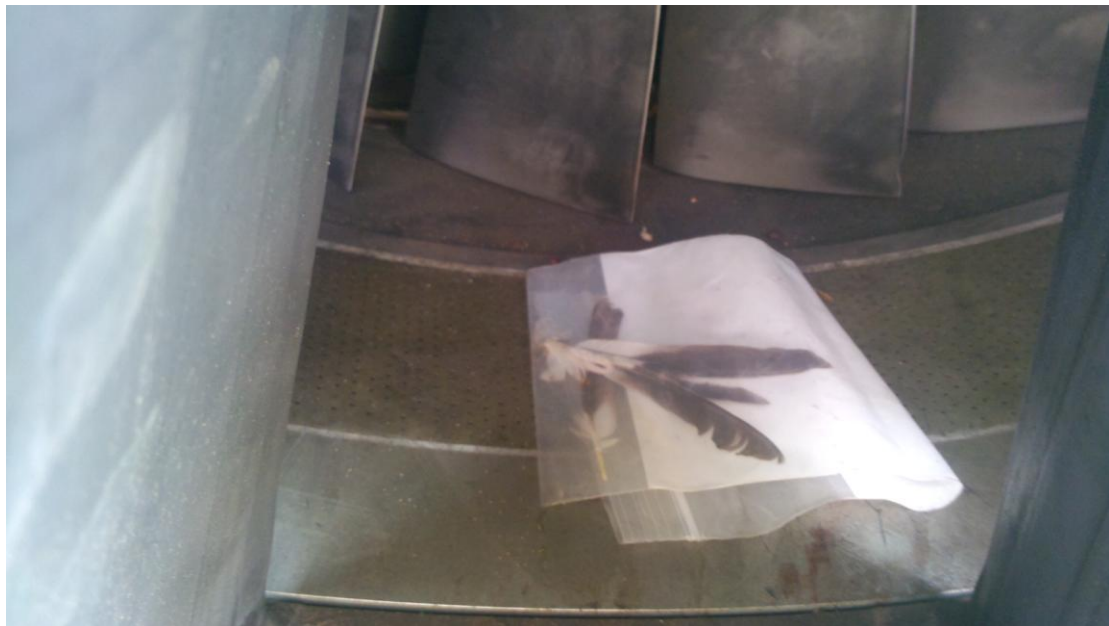
圖 3-6：事故調查實習中於發動機中的禽類羽毛。
