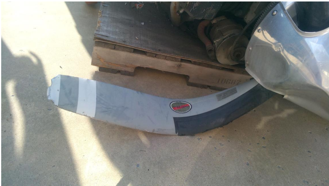
圖 3-7：螺旋槳受損彎曲的活塞式引擎。
