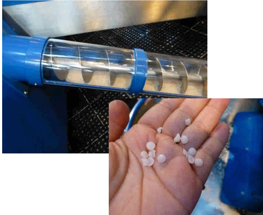
輸送帶系統中使用的材料-用塑料取代水， 比較安全也容易清理，值得學習。
