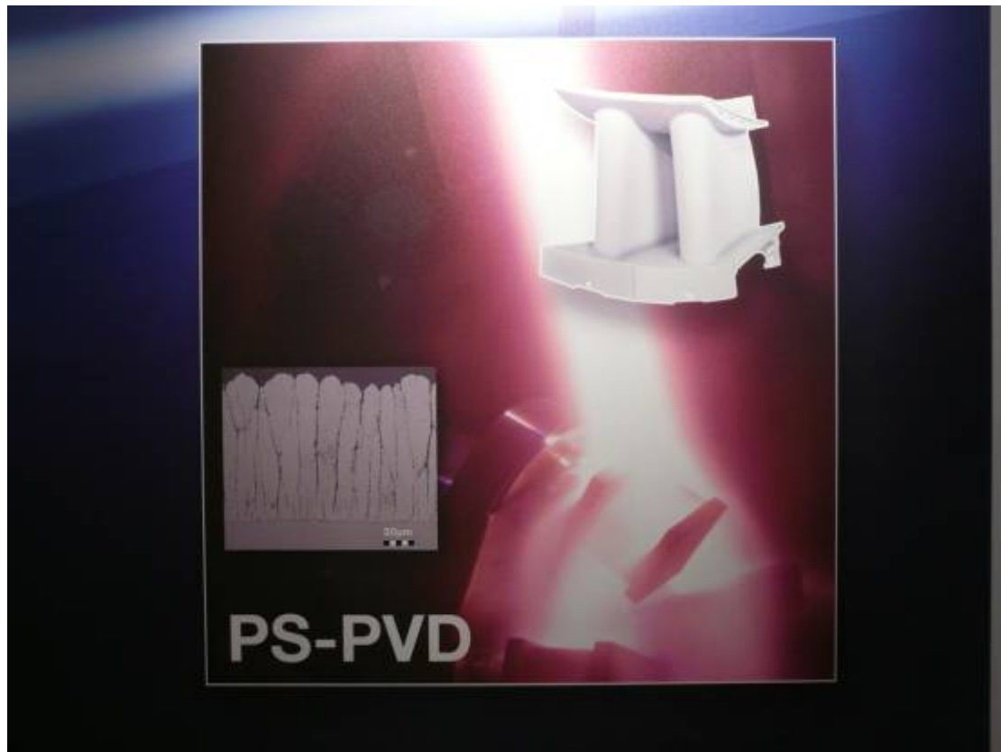
圖十二 LPPS 所噴塗之柱狀晶結構塗層
