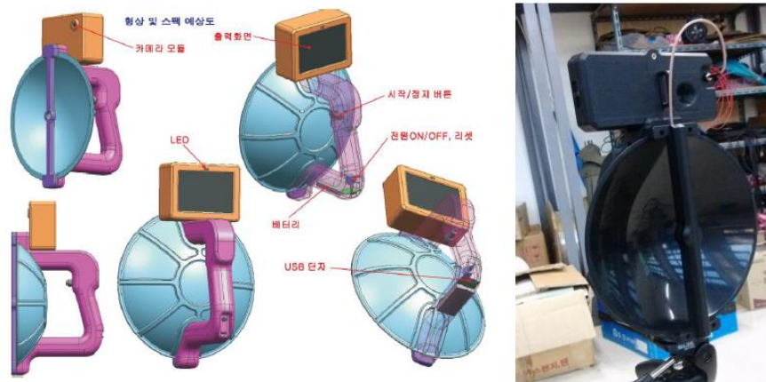
圖 3. KERI 所開發的局部放電的超音波接收器
