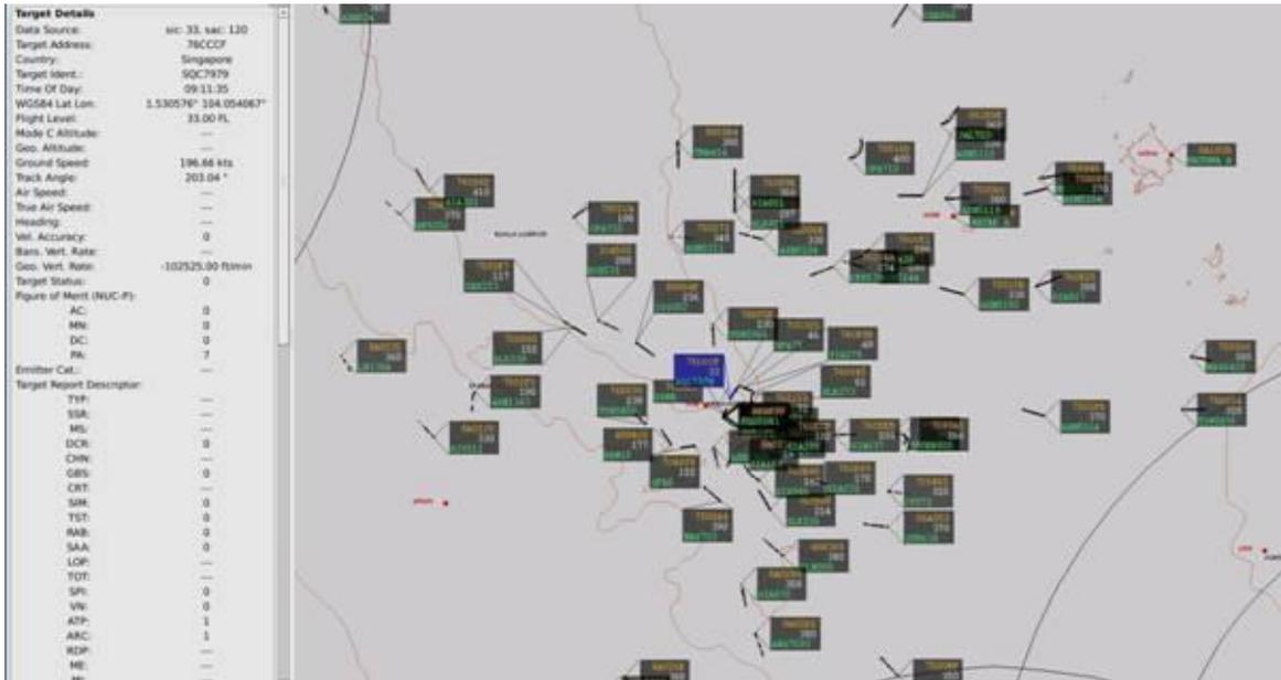
▲雅加達 ACC 管制畫面顯示來自新加坡之 ADS-B 分享訊號
