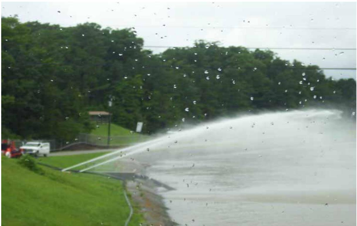
圖六 可攜式泵噴水測試
