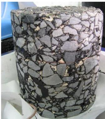
圖 2.1 面層保水鋪面鑽心試體圖
