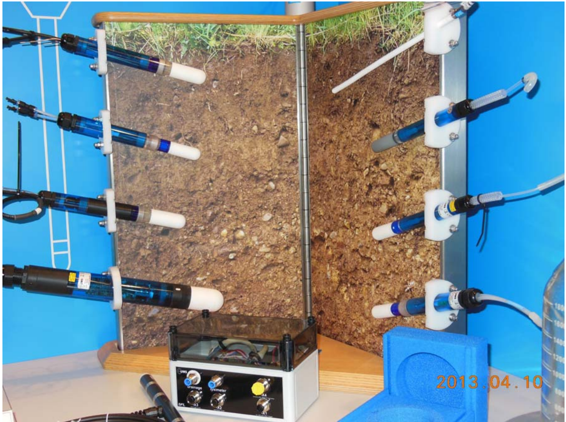
圖 6 廠商展示以 lysimeter 進行地表入滲監測情形
