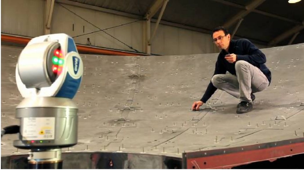
圖 4-5 雷射追蹤定位量測情形。(FARO 官網)
