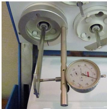
7. 網籃搖晃度確認：測量網籃下緣的搖晃程度，建議 $\leq 1.0\text{ mm}$ 內。
