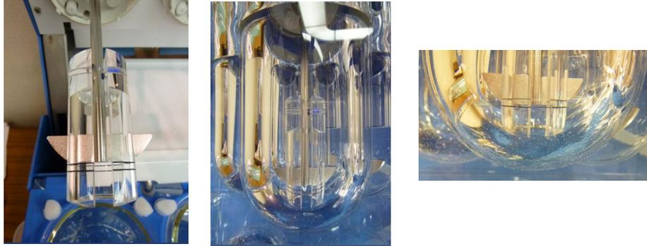
9. 旋轉速率測量：在轉軸上貼上具有反光材質貼紙，再使用電子轉速器讀取轉速，USP 雖規定轉速的偏差在  $\pm 4\%$  內(假設攪拌槳常用轉速為 50rpm，則允許偏差為  $\pm 2\text{rpm}$  內)，但建議轉速偏差應更嚴格在  $\pm 1\text{rpm}$  內，達到這個要求並不困難。
