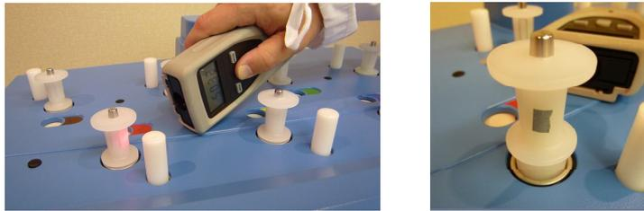
10. 溫度測量：確認溶離杯內溶媒溫度在  $37\pm 0.5^\circ\text{C}$  內才能開始實驗。
