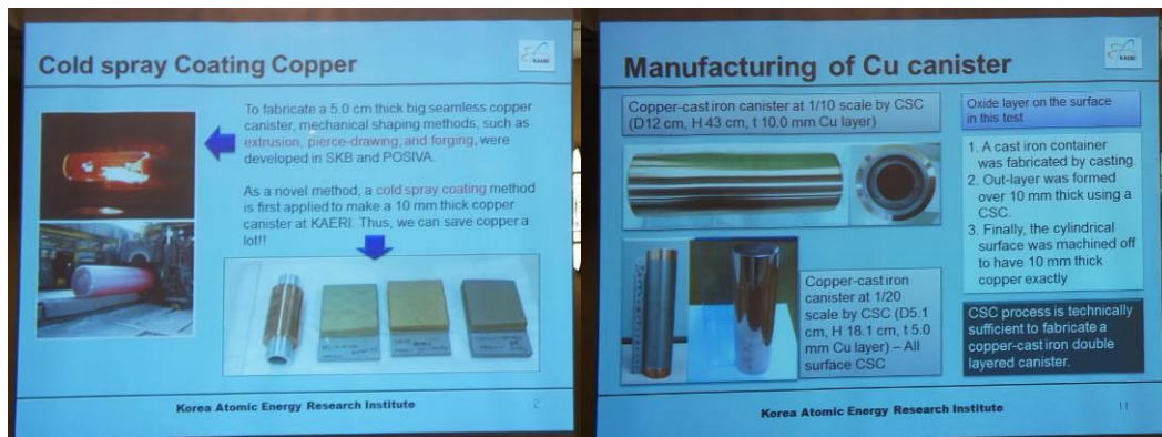
圖 15 利用 CSC 法製造鐵-銅雙層燃料罐
