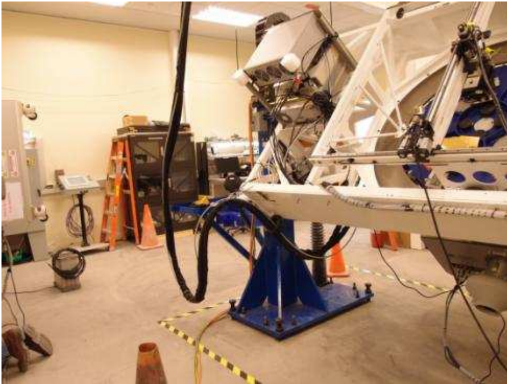
圖 17. 測試修改後氨氣管不與地面接觸方式測試結果符合預期目標
