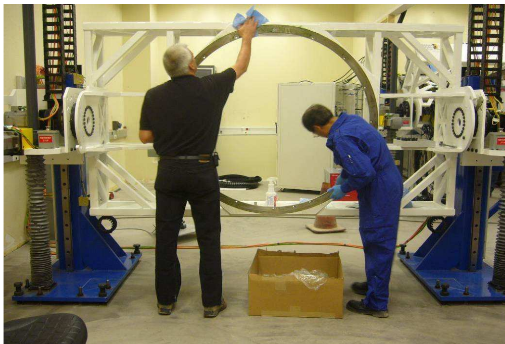
圖 12. 傾側旋轉測試檯接收機支撐板安裝前清除防銹油
