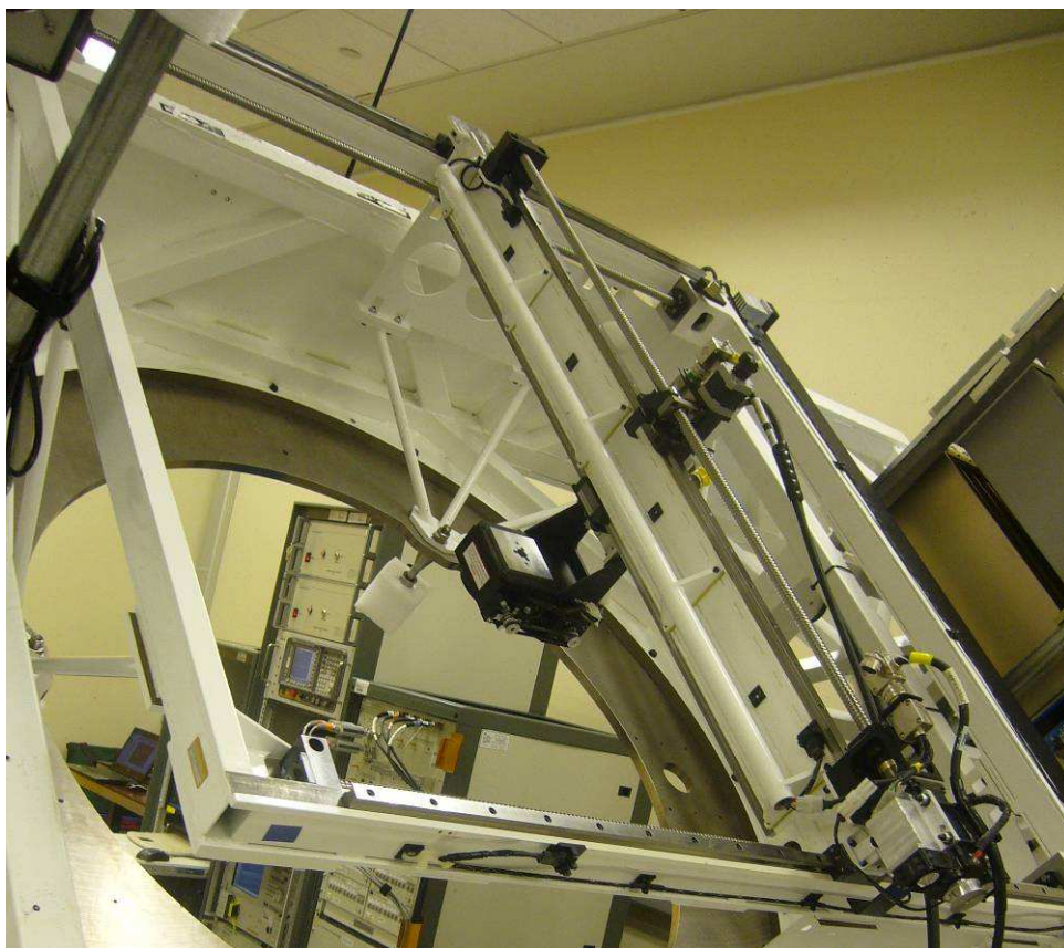
圖 22. 設定 NSI Scanner 傾斜角 60 度執行 ATP 測試
