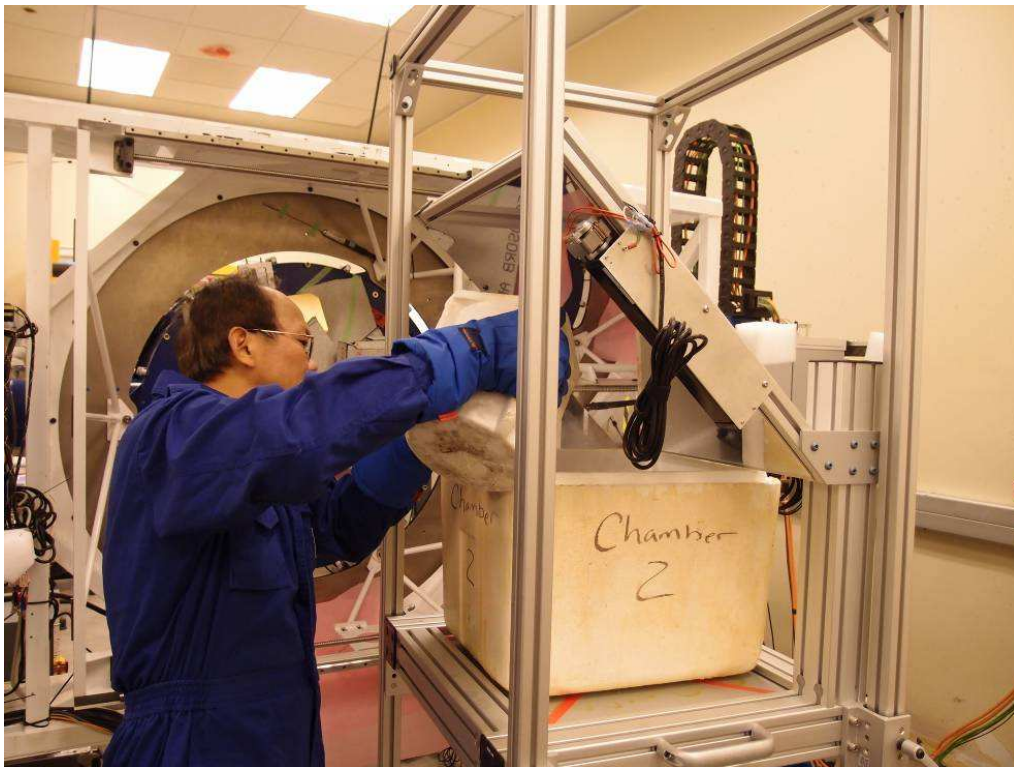
圖 31. 檢查液態氮準備執行溫度雜訊性能測試
