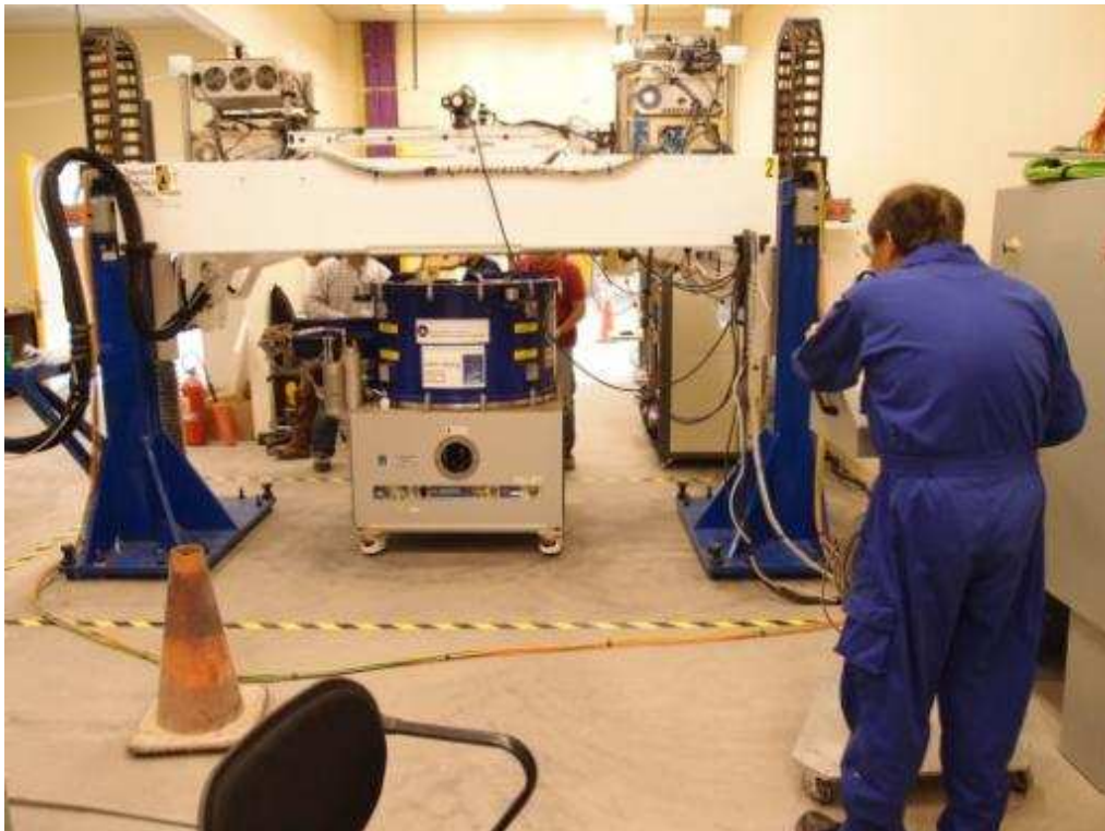
圖 16. 待測接收機 SN64 移入準備安裝於傾側旋轉測試檯
