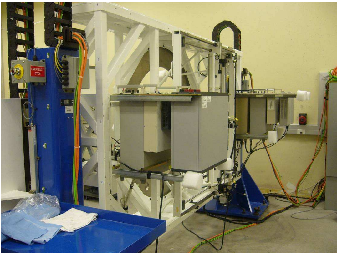
圖 27. 安裝於傾側旋轉測試檯上之相位量測系統
