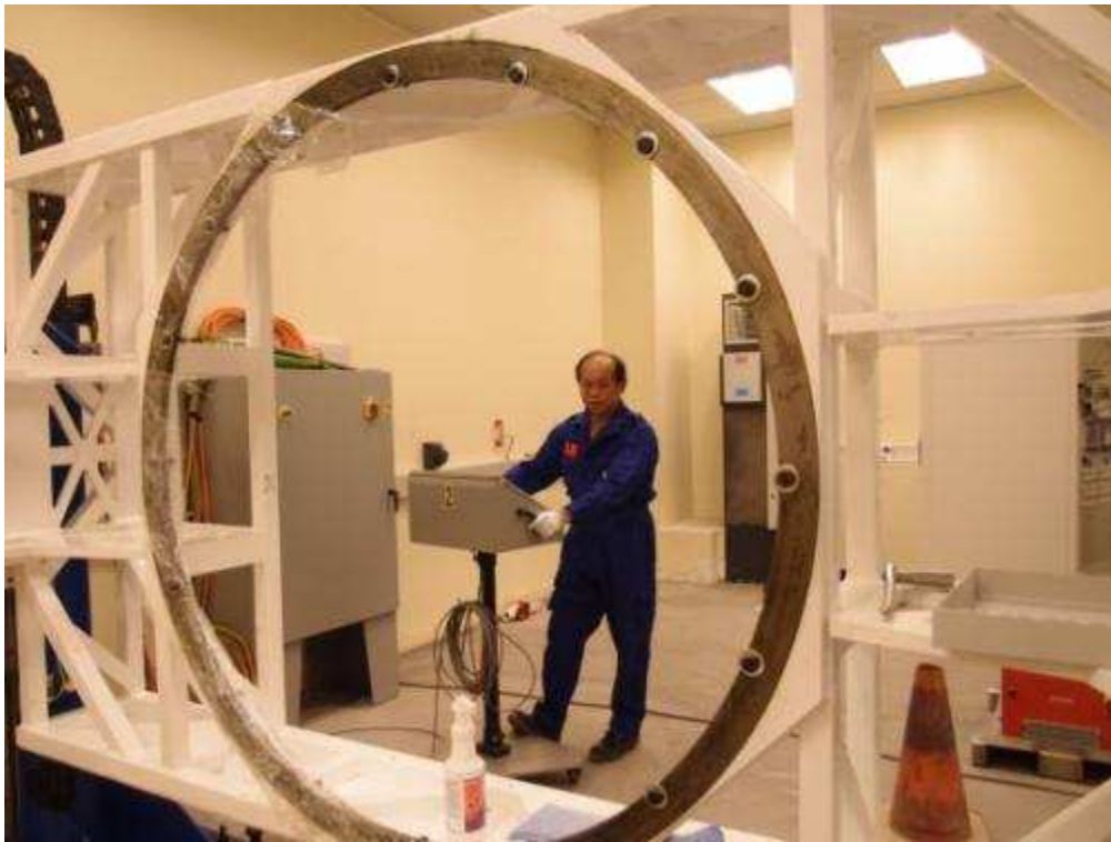
圖 11.安裝完成後，傾側檯旋轉功能測試
