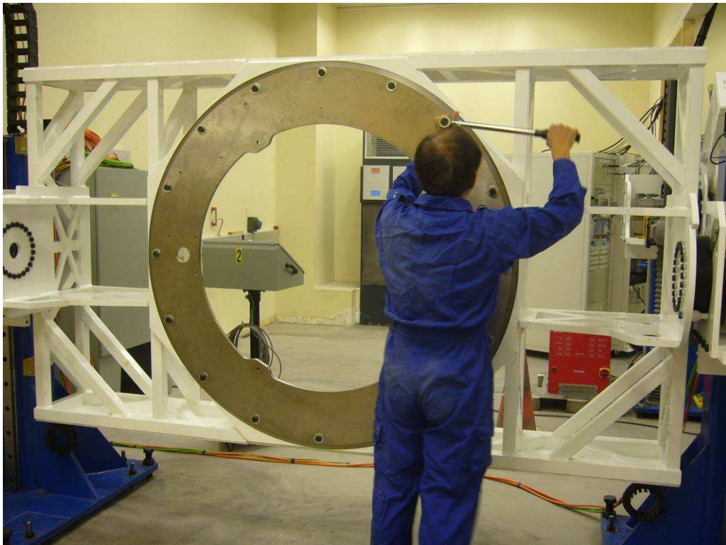
圖 14. 傾側旋轉測試檯接收機支撐板安裝螺栓上磅
