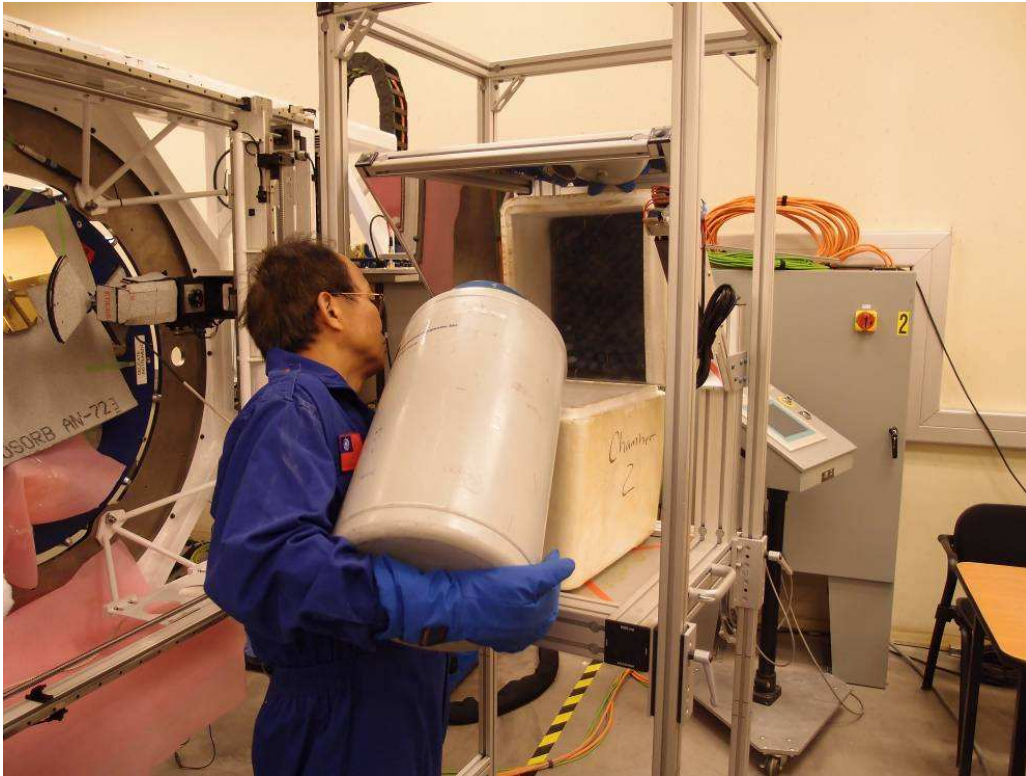
圖 30. 裝填液態氮準備執行溫度雜訊性能測試
