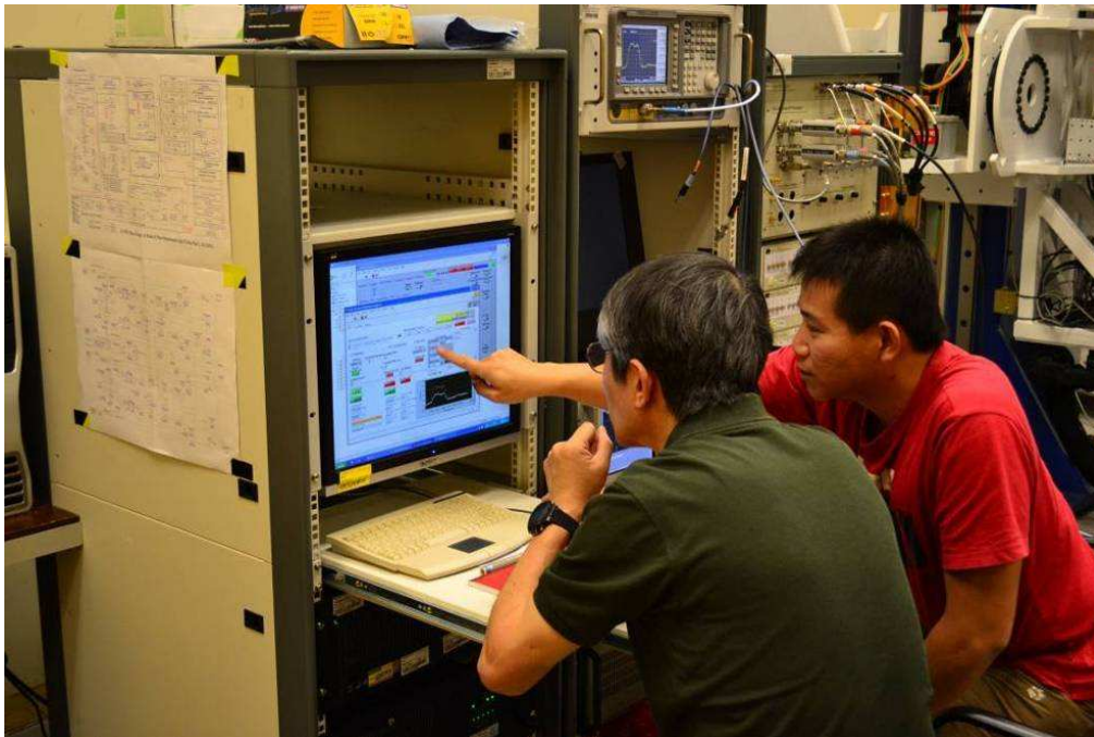
圖 41. 設定量測程式參數準備執行膺頻響應測試
