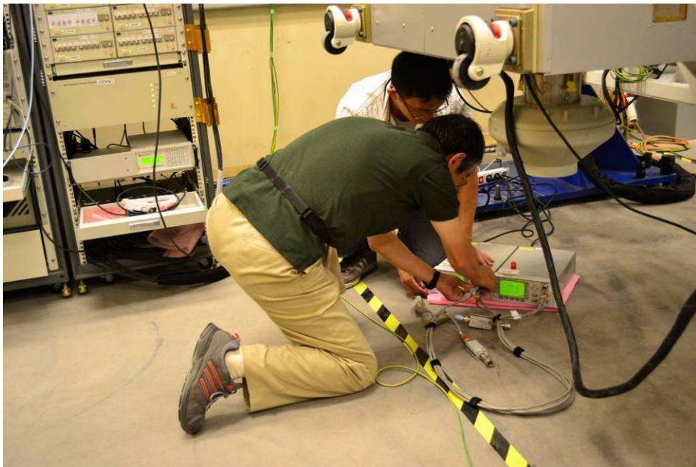
圖 48. 設定 Power Meter 準備執行振幅穩定度測試
