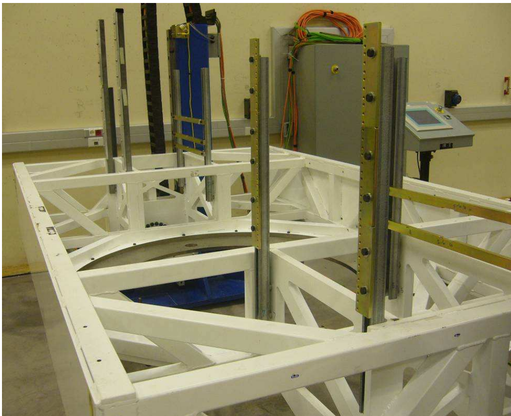
圖 18. 傾側旋轉測試檯，裝備安裝架組裝完成
