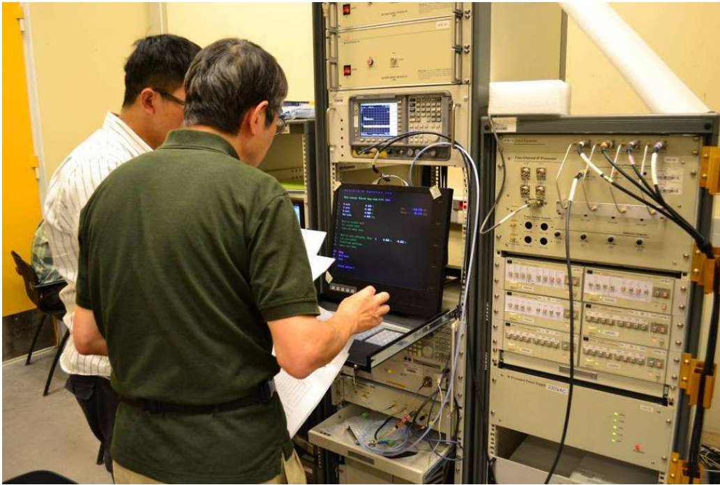
圖 66. 操作 NSI Index 準備執行 Beam Performance 測試
