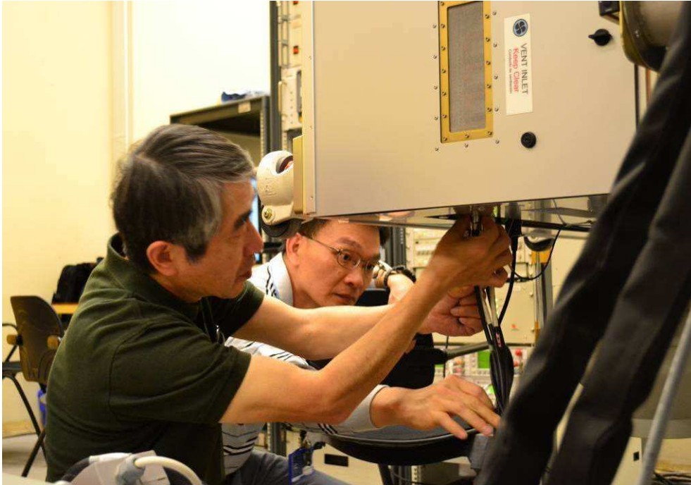
圖 39. 檢查接線準備執行膺頻響應測試
