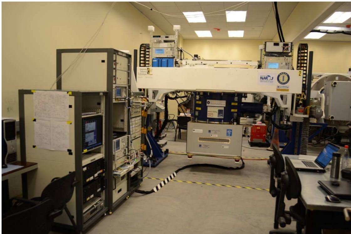
圖 1. 移交智利 OSF 維護中心之接收機量測系統
