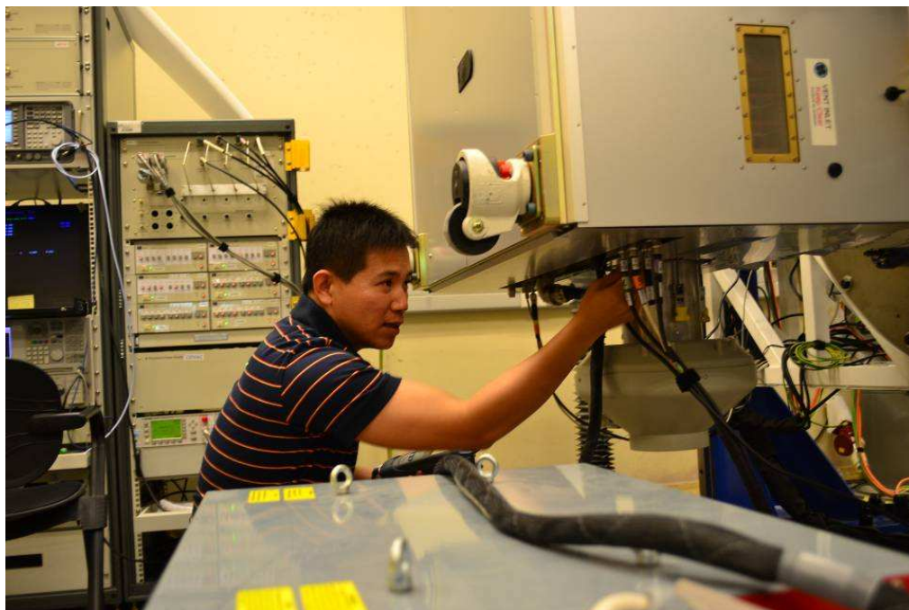
圖 33. 檢查接線準備執行溫度雜訊性能測試
