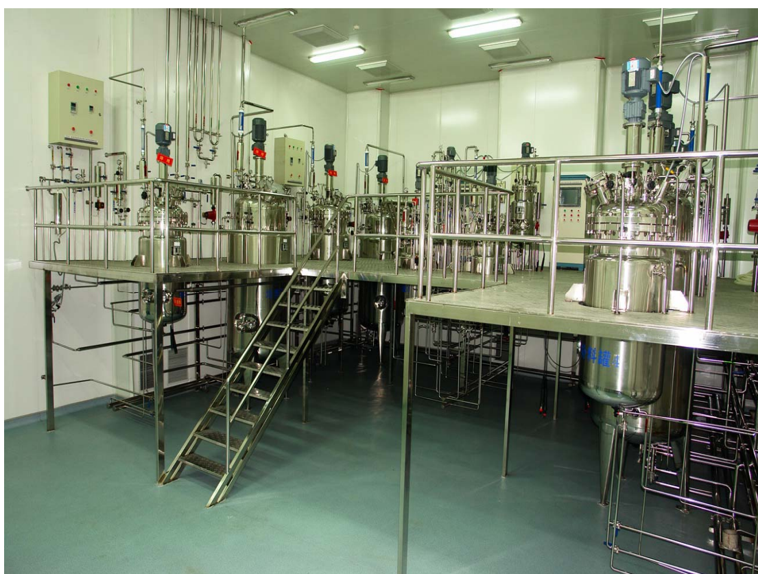
圖三十一 細菌活疫苗的發酵培養系統
