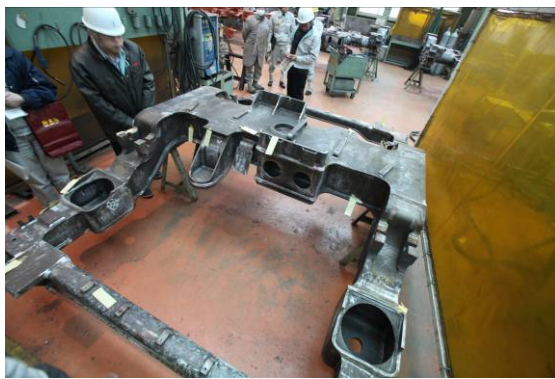
直達車量產車轉向架焊道檢查情形
