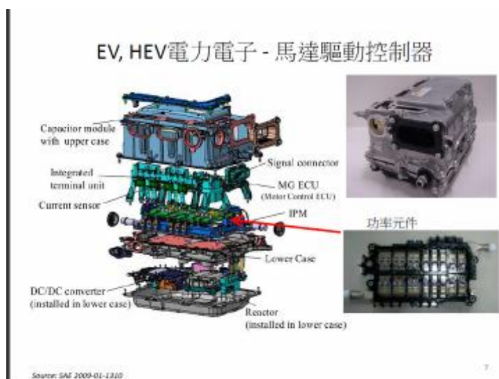
圖 3.24 電力電子馬達驅動器
