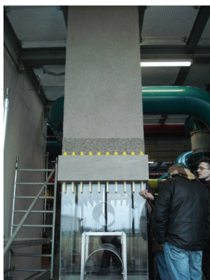
圖 38-6 漢堡水務中/東部(Mitte / Ost)淨水場實場規模之快濾模型設備
