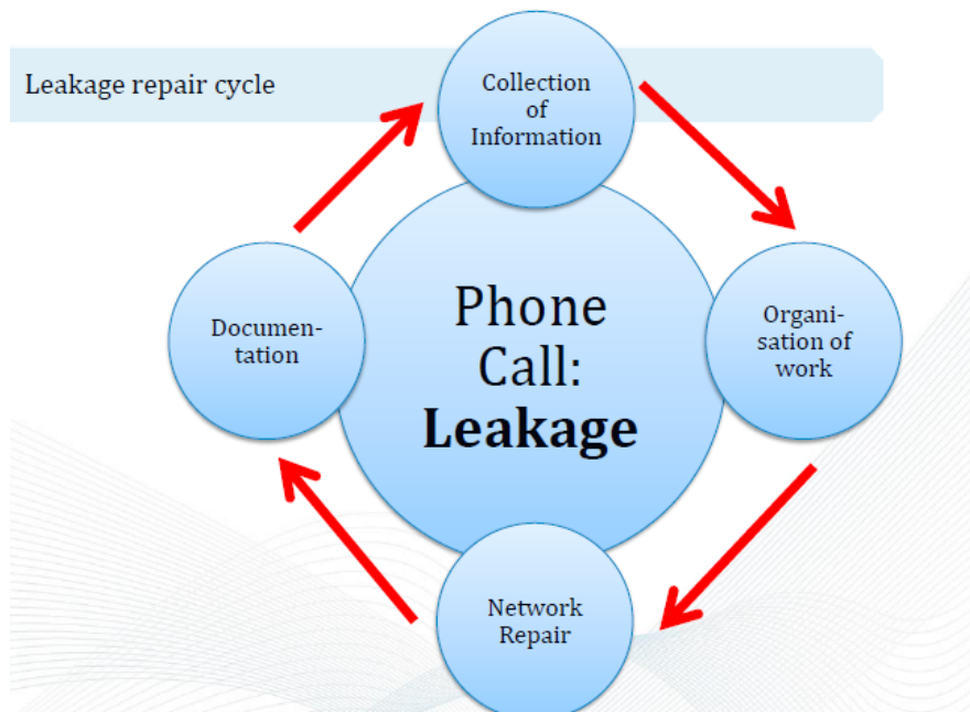
圖 29 漢堡水務管線修漏作業循環
