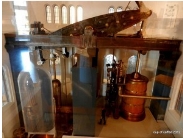
圖 39-5 漢堡水博物館-1/20 比例之科尼什蒸汽抽發動機模型-早期抽水設備
