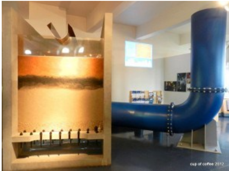
圖 39-13 漢堡水博物館-現代漢堡地下水淨水處理過濾設備
