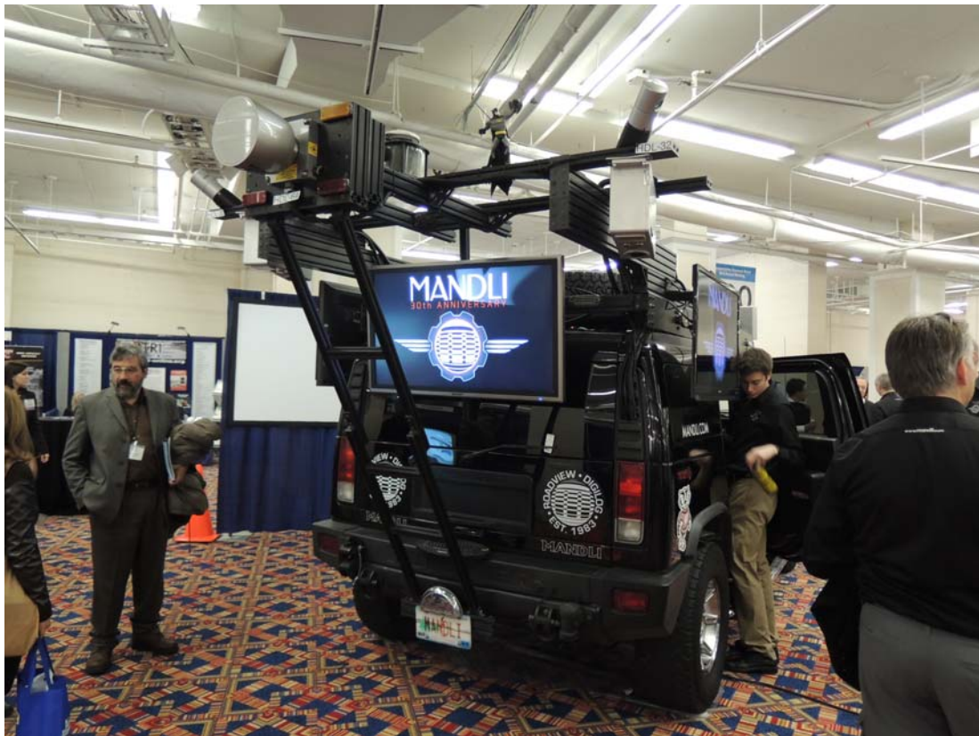
圖 20 Mandli 的 LiDAR 三維資料蒐集系統車
