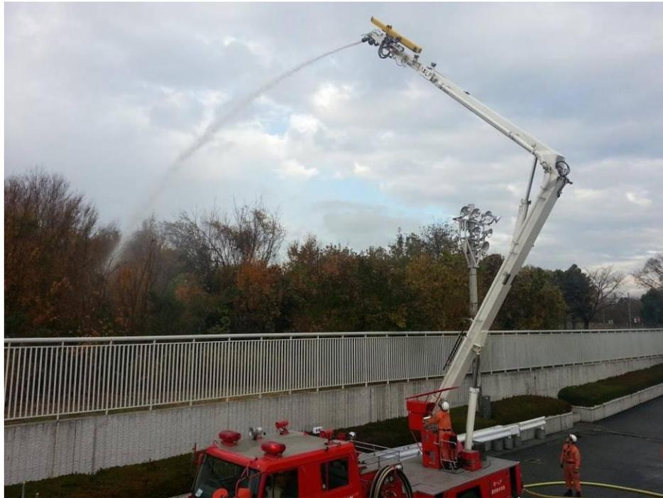
圖 85 屈折放水塔車結合遠距離大量送水裝置射水情形
