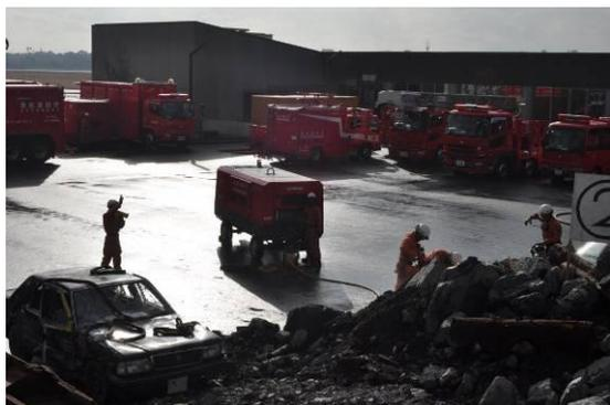
圖 81 使用空壓車操作破壞器材
