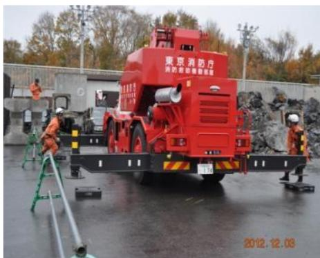
圖 41：於腳架位置放置墊板
