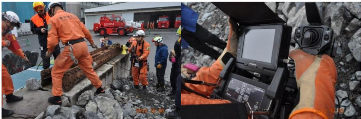
圖 63：光纖探測器—動作原理同生命探設器，其優點是鏡頭較小容易深入較小縫隙搜索人命，前方鏡頭可利用本體遙控器將鏡頭旋轉，其搜索角度更加廣泛。
