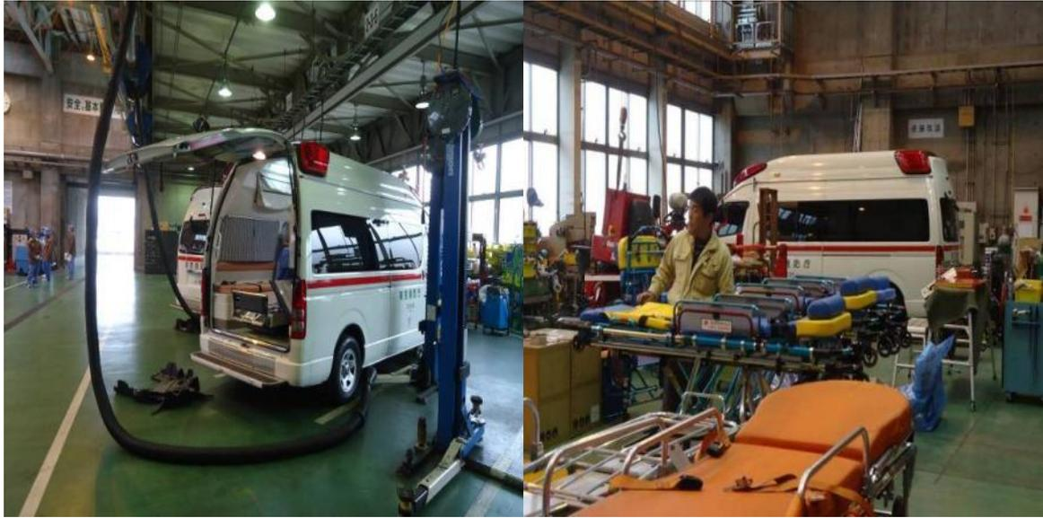
圖 16：裝備工廠中救護車之拆解檢修
