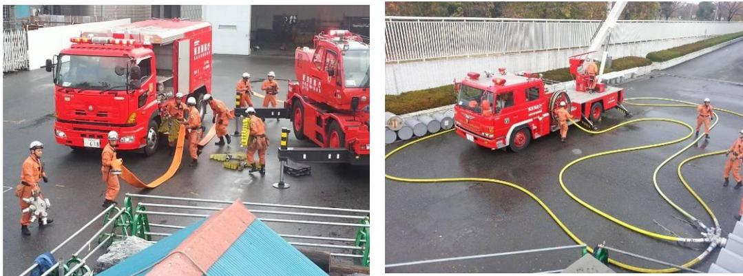
圖 86、87 6 英吋消防水帶延長，轉接成四條 2.5 英吋水帶送水到屈折放水塔車
