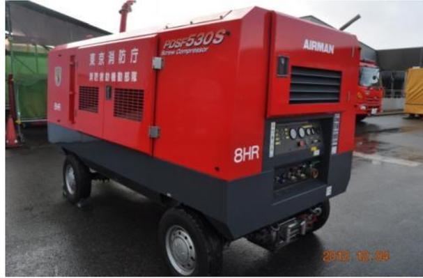
圖 65：移動式空壓機—利用汽油引擎帶動發電機，能於救災現場直接提供壓縮空氣給氣動式器材、設備，在台灣大多已配備於救助器材車內。
