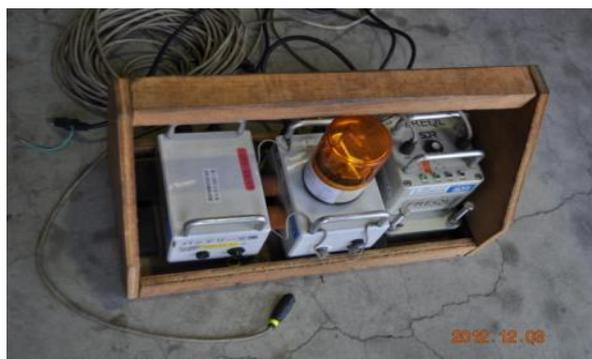
圖 64：早期地震預警器—利用地震發生時先傳送的 B 波、S 波，可提早接收到地震傳送的訊息，藉由警示燈及警報器通知救災人員，於餘震到達前先行撤離救災現場。
