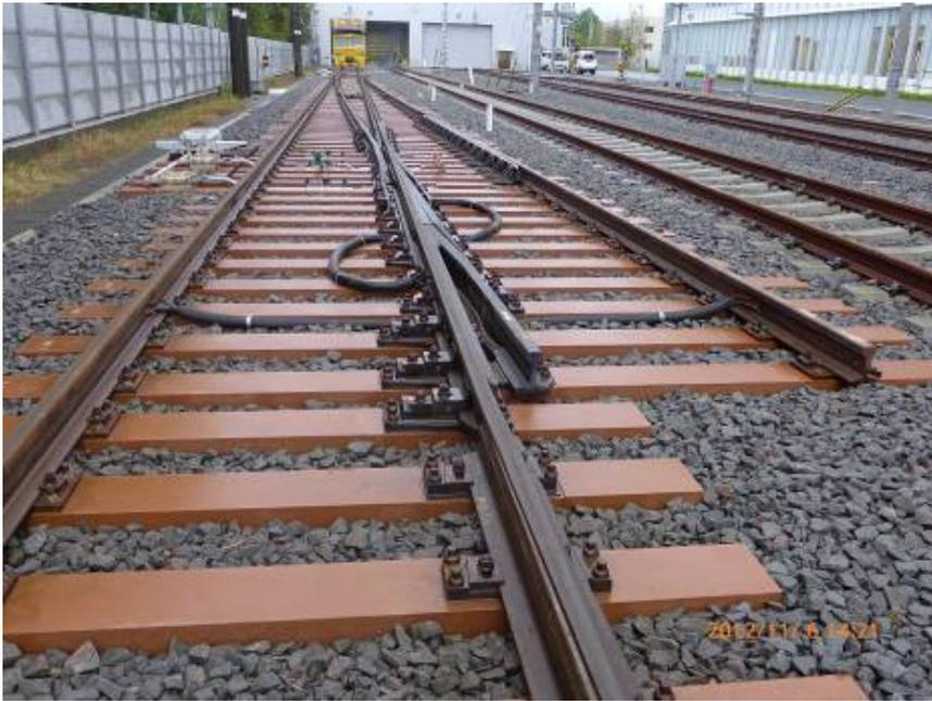
圖十五 日本新幹線 18 號高速道岔可動式岔心結構(攝自 JR 東海研修中心)
