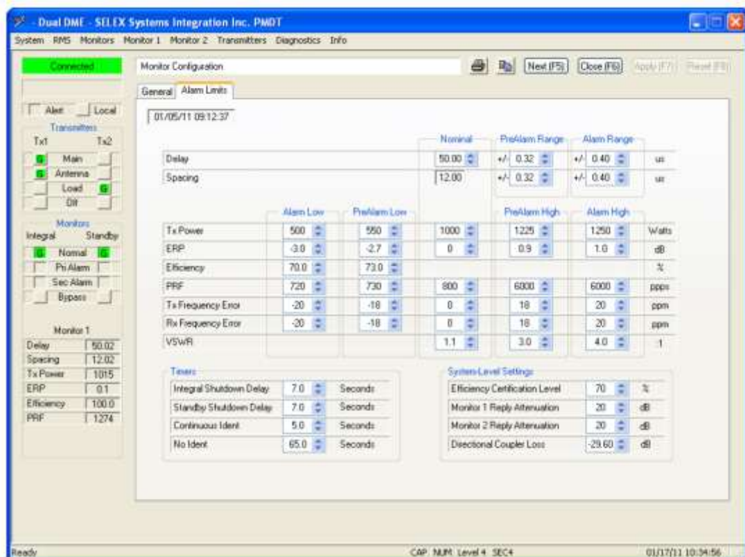
圖 1-3-4-2 Monitor alarm limit 頁面。
