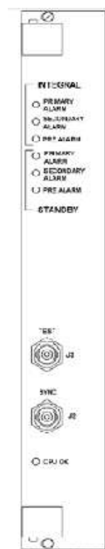
圖 2-4-6b Monitor 板卡面板
