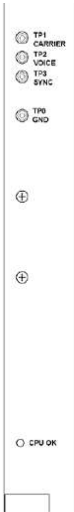
圖 2-4-5a Audio Generator 板卡面板圖
