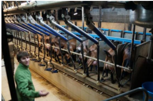
魚骨式擠乳器，上方可移動，可減少擠乳器的數目
