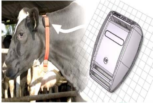
HR 系統為掛於牛隻頸部之電子盒，內嵌有移動感測器及微型麥克風。
