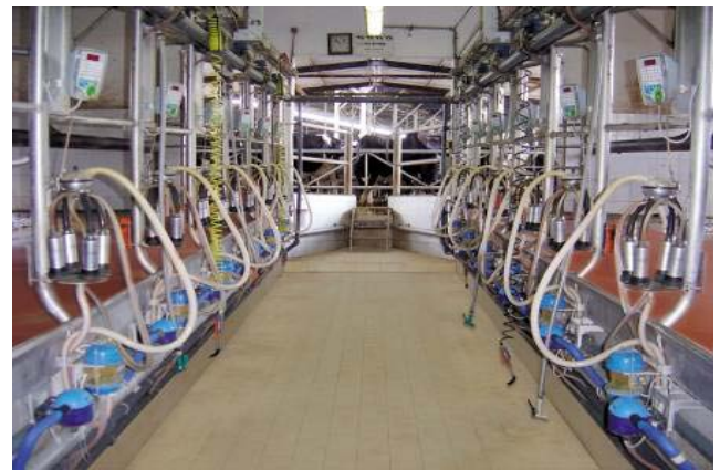
擠乳線上即時乳質分析器及其在擠乳間擠乳系統之配置
