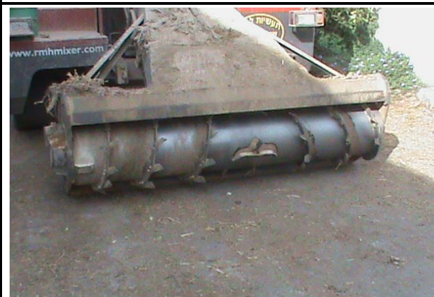
TMR 混合車及其自動採取原物料裝置與擷取玉米青貯料
