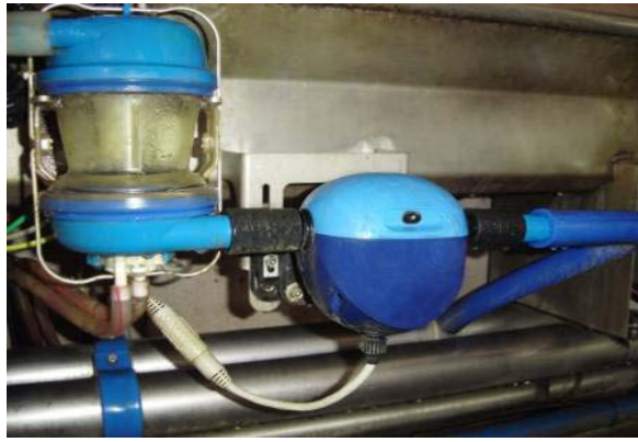
擠乳線上即時乳質分析器及其在擠乳間擠乳系統之配置
